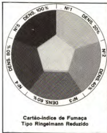
Utilizada corretamente, a escala Ringelmann mede a densidade da emissão da fumaça
