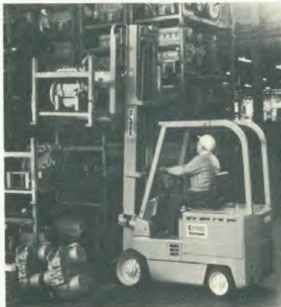
A Clark lançou nos EUA uma nova linha de empilhadeiras elétricas, com capacidades de 6 000, 7 000 e 8 000 libras (2 700, 3 100 e 3 600 kg) que operam com baterias de 36 ou 48 volts. Segundo o fabricante, elas combinam as facilidades de manobra das
