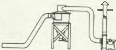
**Sistema de transporte pneumático e seus componentes: 1) receptor e alimentador adequados para cada produto; 2) ventoinha; 3) tubulação de transporte; 4) sistema Venturi; 5) sistema de sucção.**
