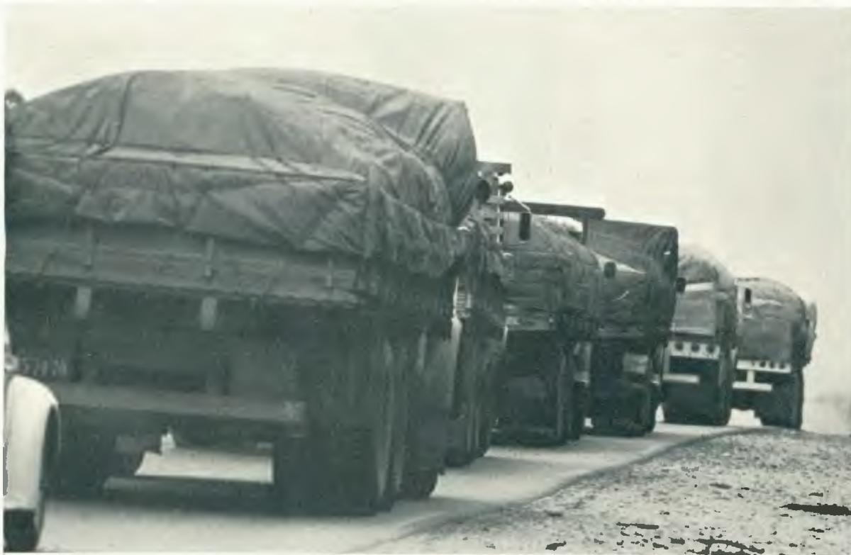
Terceiro-eixo: nos médios ou nos pesados, aumenta a relação carga útil/pêso total e reduz a velocidade.
