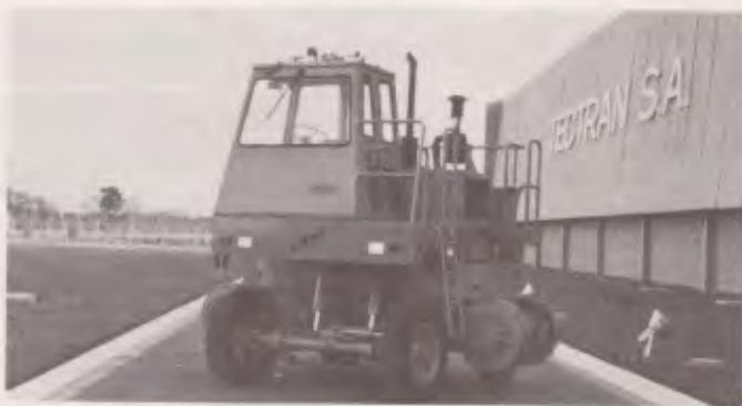
que e caixa de transferência 1:1,14. Sua velocidade de deslocamento atinge 17 km/h sobre trilhos e 7,5 km/s sobre pneus.
