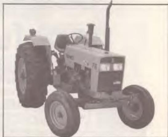
A Série Prata da Valmet ganhou mais um integrante. É o modelo 78, com 73 hp, direção hidráulica hidrostática, câmbio sincronizado, motor MWM 229 de quatro cilindros (injeção direta) e embreagem independente para
