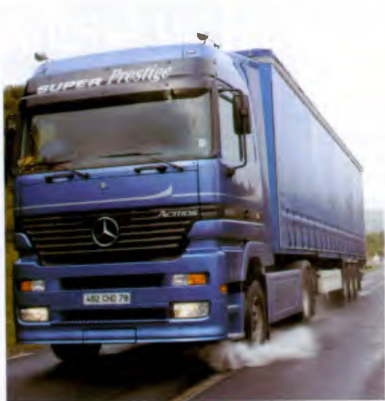
O sistema Anti-Splash, da Michelin, reduz esguicho provocado pelos pneus dianteiros em pista molhada
