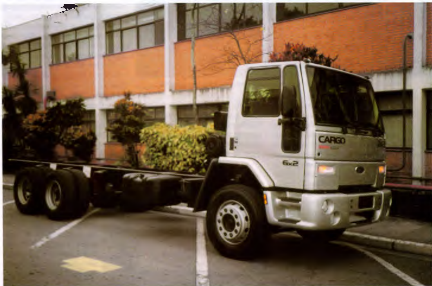
Cargo MaxTruck 2422, com 24 toneladas de peso bruto total técnico, da nova linha de veículos 6x2 de fábrica
