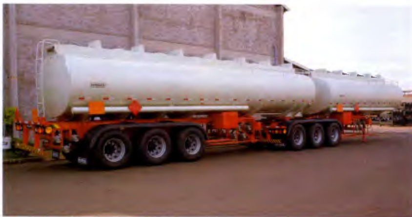
Bitrem tanque, de 9 eixos, com 17,83 m de comprimento, da Noma
