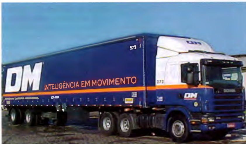
Carreta sider com eixos espaçados: 15,20 m de comprimento e 30 paletes
