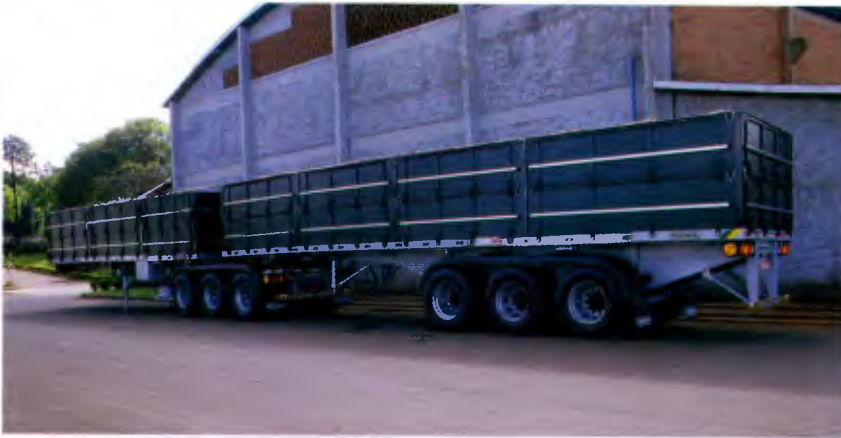
Bitrem graneleiro de 9 eixos e pbtc de 74 t, para volume de 67,22 m 3
