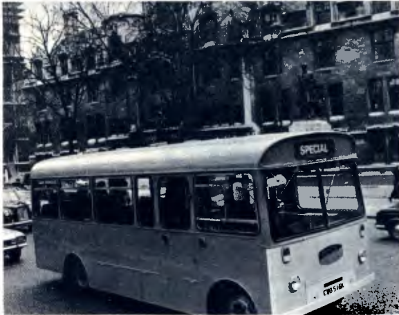
Trafegando sem paradas, o ônibus a bateria tem autonomia de até 122 km.
