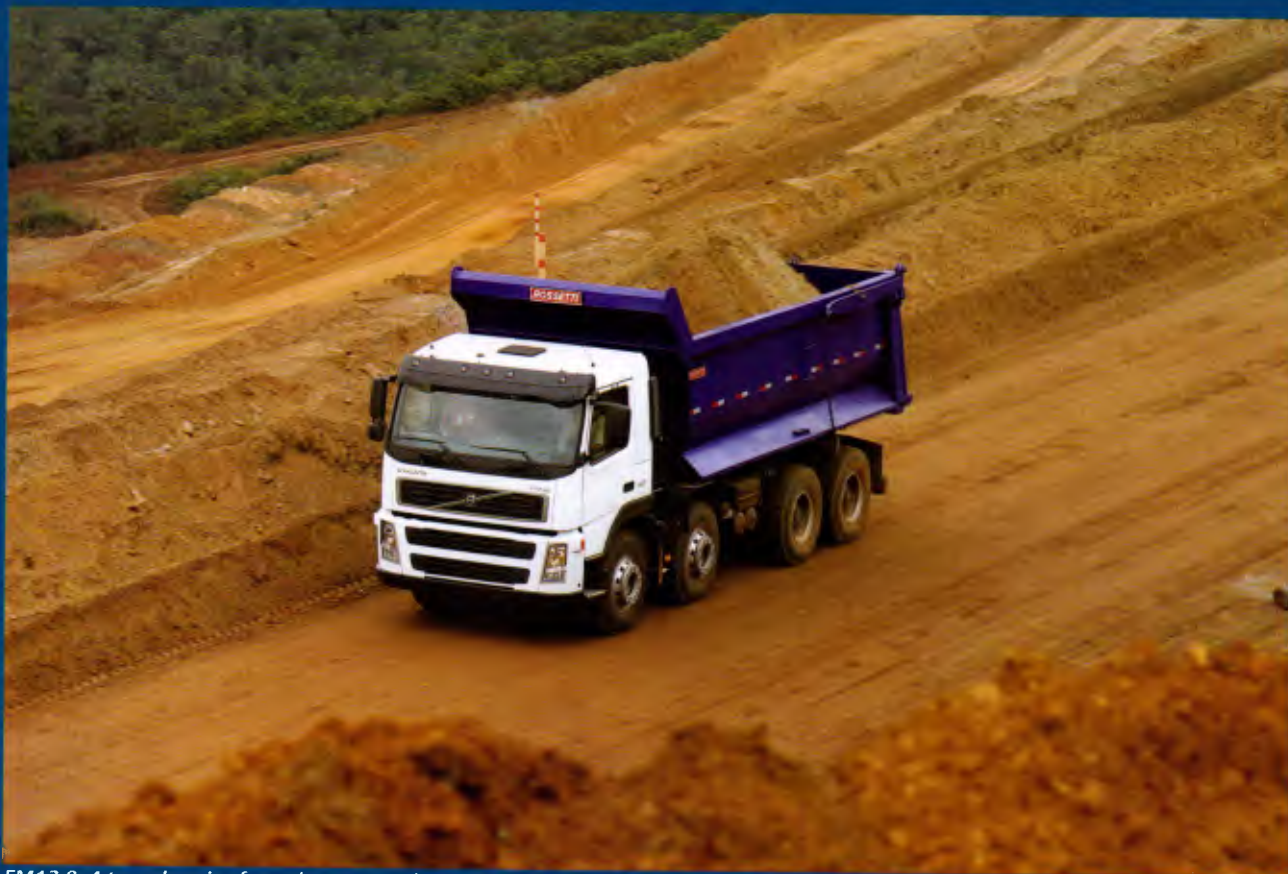
FM12 8x4 tem chassi reforçado e motor de 420 cavalos para aplicações pesadas tanto nas rodovias como fora-de-estrada
