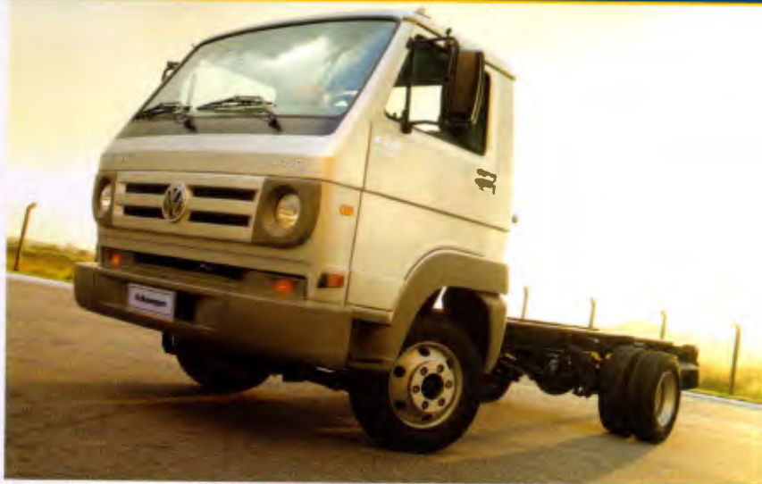
Os caminhões Delivery são equipados com motores eletrônicos MWM de alta rotação; nos Volkshbus, a posição do motorista está alinhada com a porta dianteira
