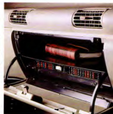
Caixa de fusíveis no porta-luvas
