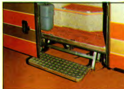
Na porta central, degrau hidráulico
