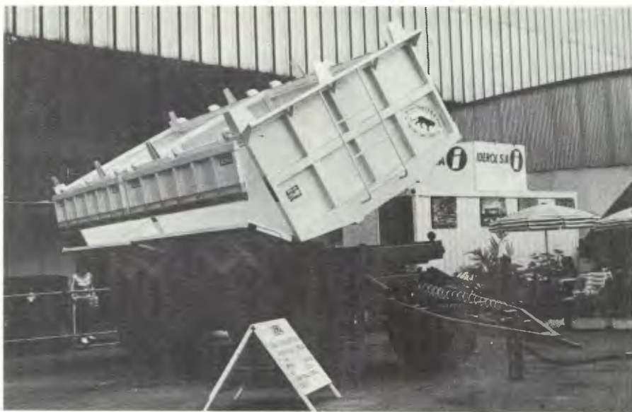
Abertura trilateral, a grande novidade deste semi-reboque para 16 t ou 20 m 3
