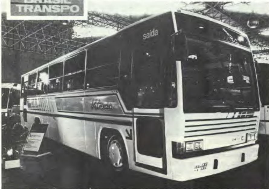
Entre as novidades: frente chanfrada, vidro dianteiro e grade frontal inteiriços
