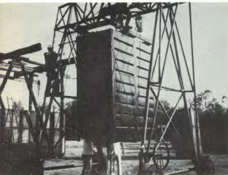
Uma talha simples carrega e descarrega os contêineres
