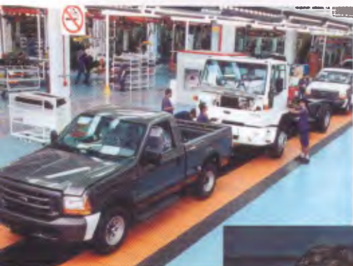
As peças seguem junto com cada veículo durante a montagem
