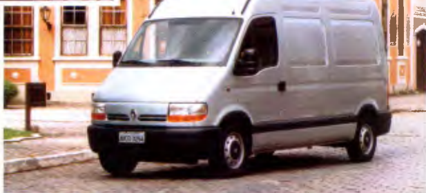
O Master 2.8, de aspiração natural ou turboalimentado, faz cerca de 10 km com um litro de diesel
