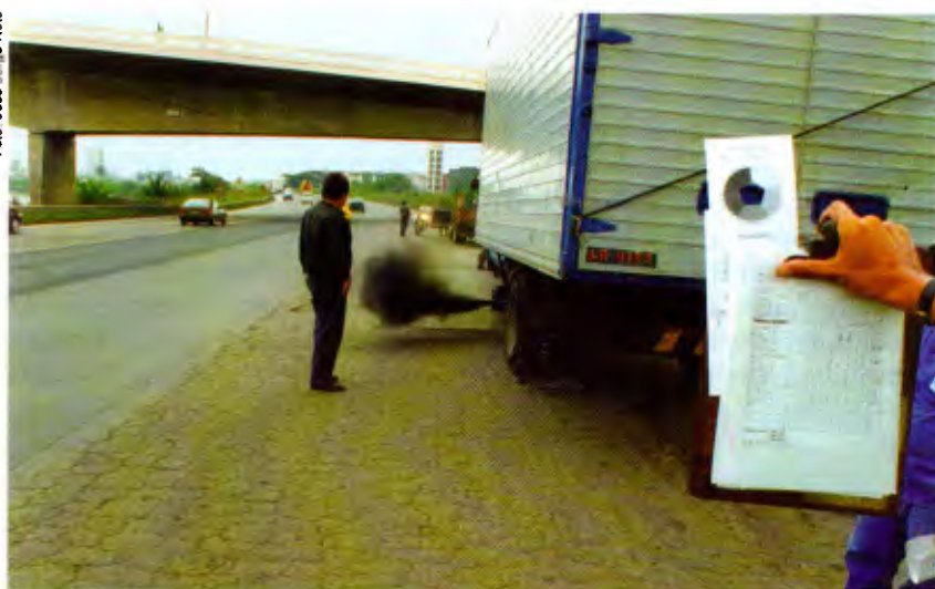
Teste para verificar se as emissões ultrapassam os limites legais
