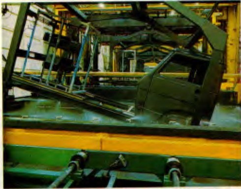
Sistema de pintura - Com fases de fosfatização e E-Coat (proteção catódica), utiliza tecnologia de nível internacional, garantindo maior durabilidade e qualidade final.
