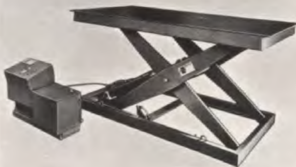
Mesa-elevadora: alimenta prensas e carrega veículos.
