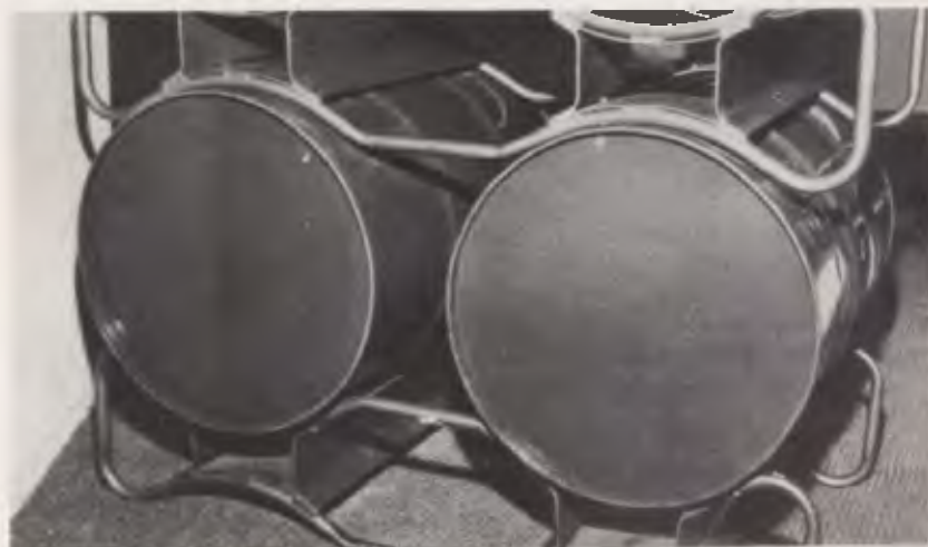
Estocagem: deitar os tambores sobre bases apropriadas evita acidentes.
