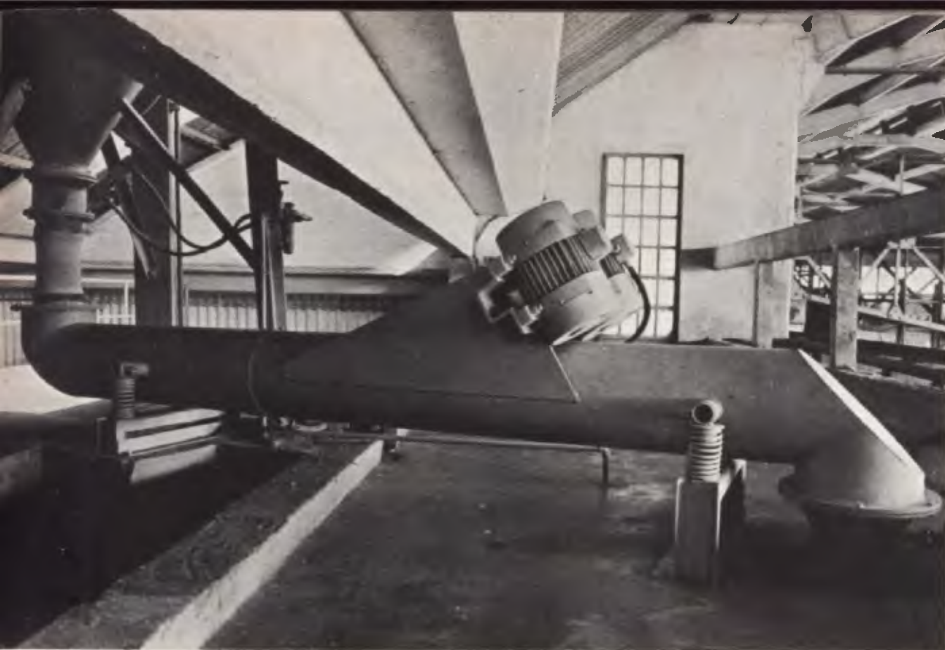
Tubo vibratório foi solução adequada para movimentação de cimento na Eternit: movimenta de 12 até 15 t/h.
