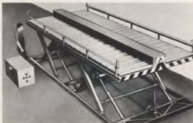
Dotada de rolêes, essa mesa eleva cargas até 2 t.
