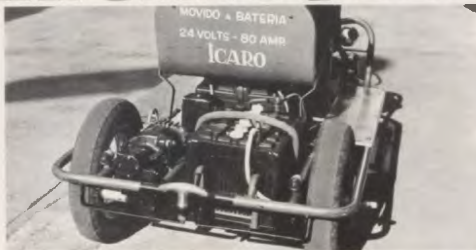
Coronado: 1,24x0,62 m e duas baterias de 12 V cada para oito horas de uso.
