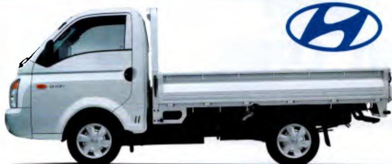
**Motor diesel** – Hyundai 2,5 litros, 4 cilindros em linha, 8 válvulas, 94 cv a 3.800 rpm, torque de 220 Nm, turboalimentado e intercooler. **Transmissão** – manual, de 5 marchas
