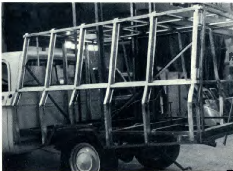
Um reforço na suspensão compensou o aumento de peso da estrutura.
