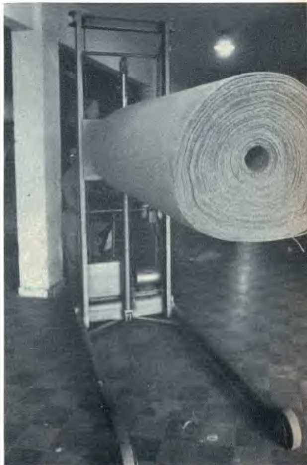
A solução foi adaptar o aríete ao trem de elevação.
