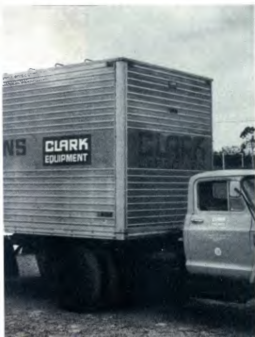
A fibra de vidro e o alumínio começam a ser utilizados nos tanques.
