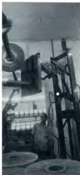
O braço pantográfico eleva a bobina até a máquina "Kettenstul".
