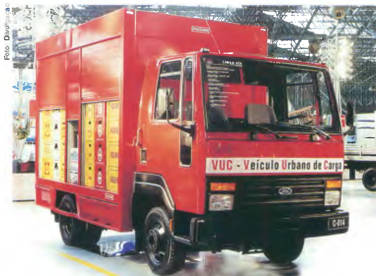
O Cargo 814 VUC, com distância entreeixos de 2.800 mm: ótima manobrabilidade
