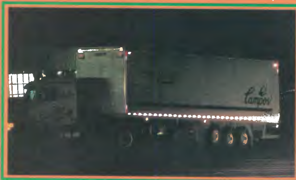
Faixa refletiva: uso obrigatório para veículos de carga com PBT acima de 4.536 Kg
