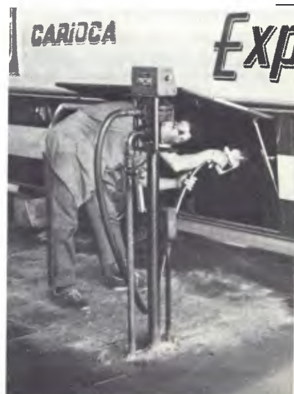
Bomba de diesel: sem roubar espaço
