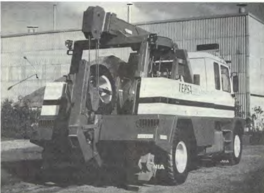
Os pés de apoio se ajustam ao tipo de pavimento: para terra ou asfalto
