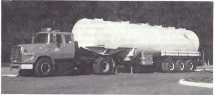
O tanque auto-portante que carrega 1 500 kg mais e o silo com sistema de aeração
