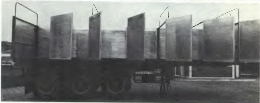
A carreta monobloco para botijões e a especial para concentrados
