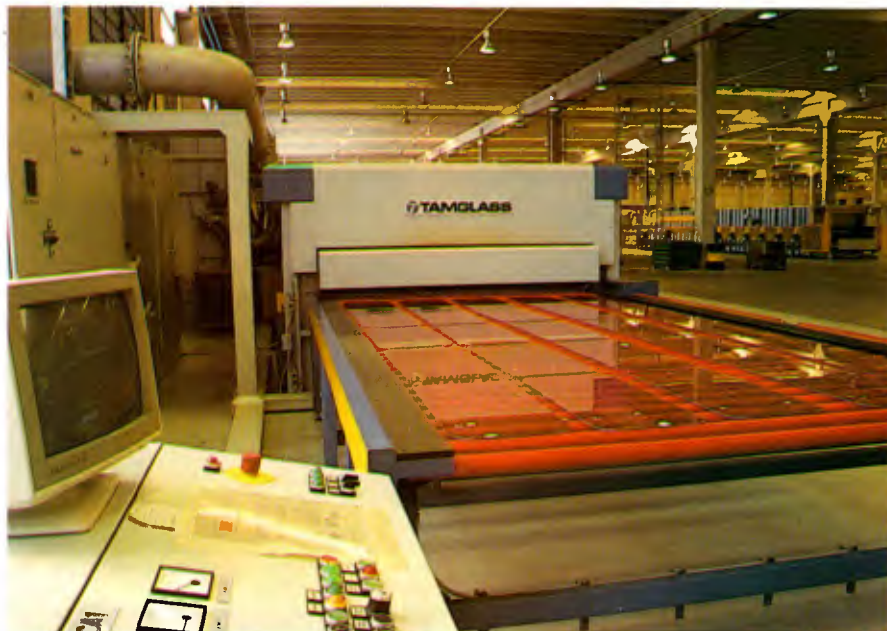
Forno finlandês tempera vidros sem indentação
