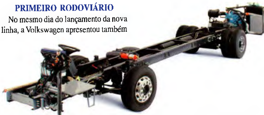
VW 17.260 EOT, com motor traseiro de 260 cv, destina-se aos corredores urbanos
