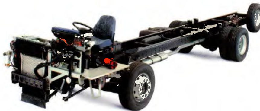
VW 15.180 EOD, para ônibus médio com comprimento máximo de 11 m e carga de 15 t
