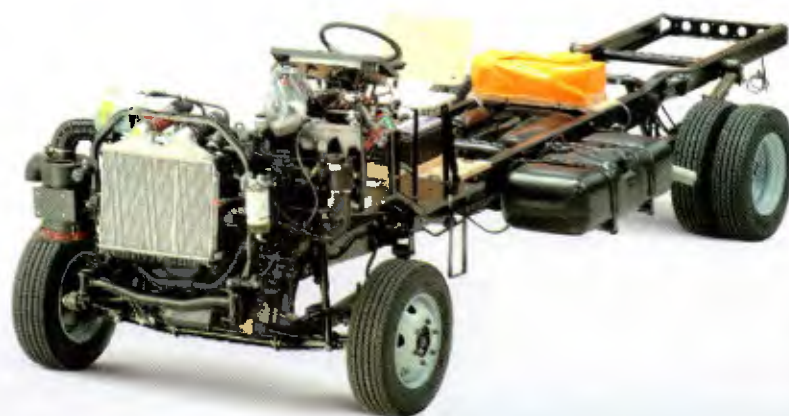
Chassi LO 915 para microônibus possui motor eletrônico de 150 cv
