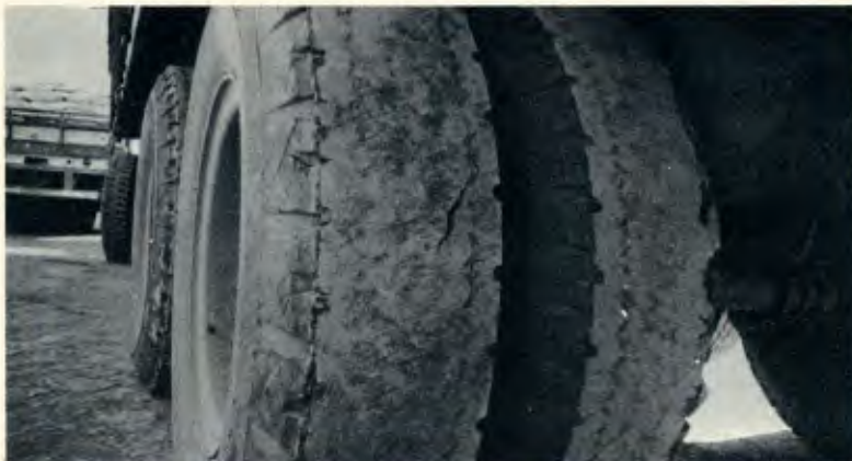
Pneus sem frisos e com fissuras profundas: um capital perdido por desleixo.
