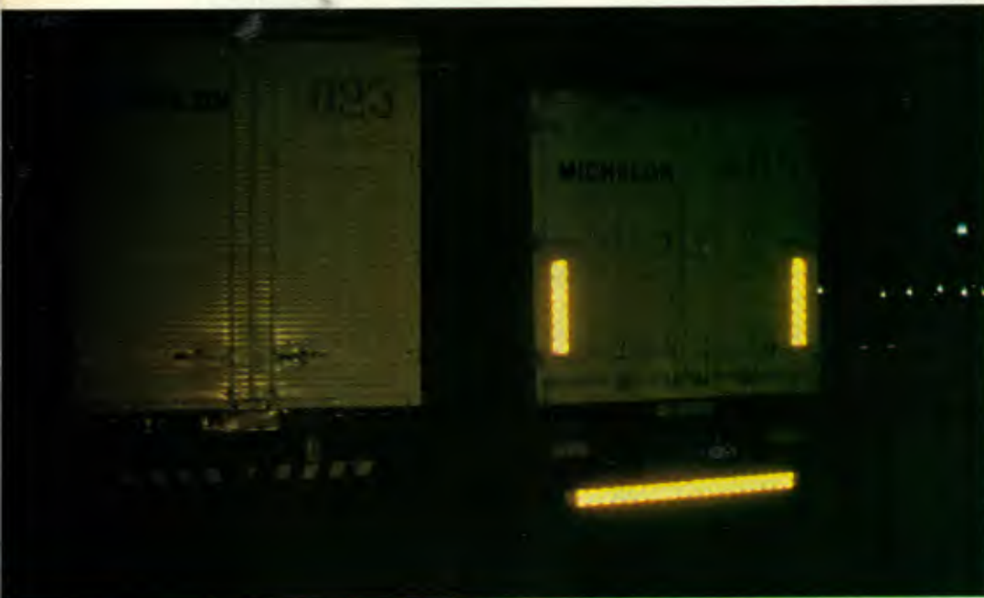
Refletivas garantem a visualização do veículo à noite em caso de pane elétrica
