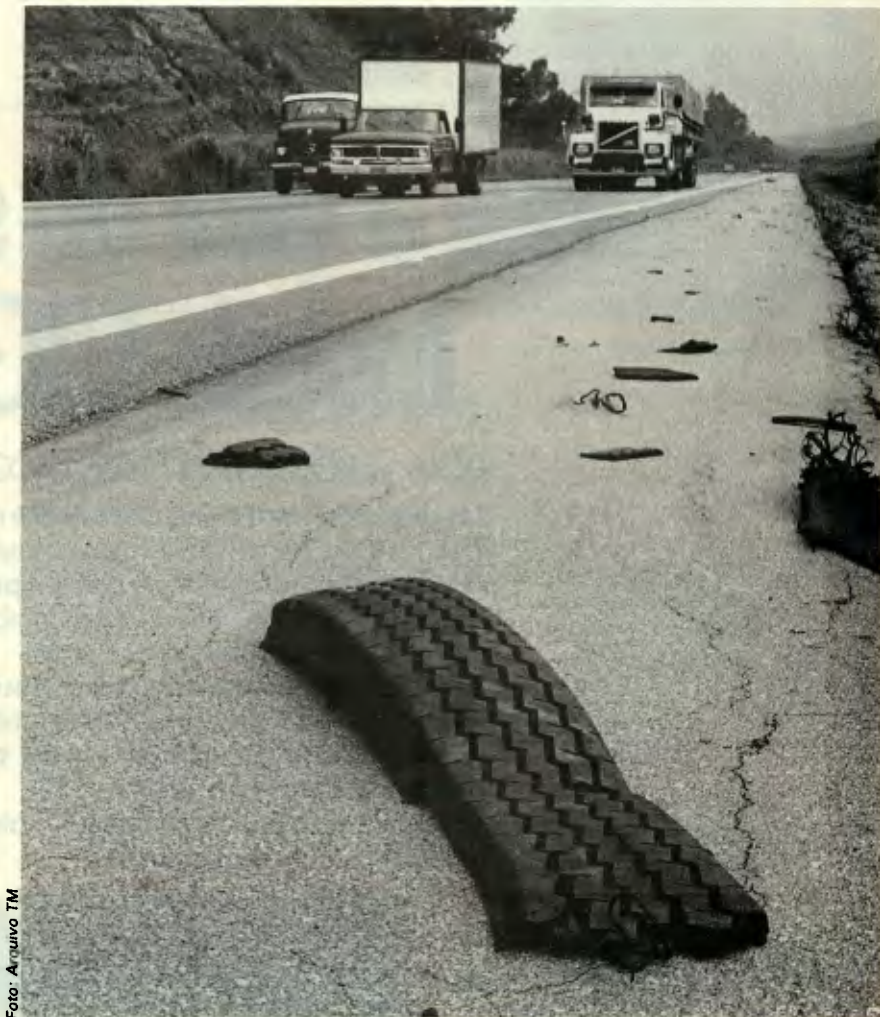
As cascas jacarés: provas inseguras de recapes feitos sobre carcaças perfuradas
