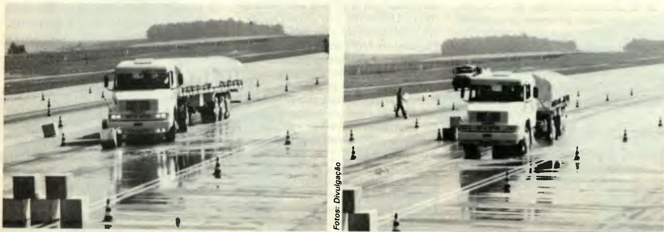
Sem ABS (à esq.), o veículo derruba o obstáculo; com o equipamento (à dir.), consegue contorná-lo e mantém a dirigibilidade
