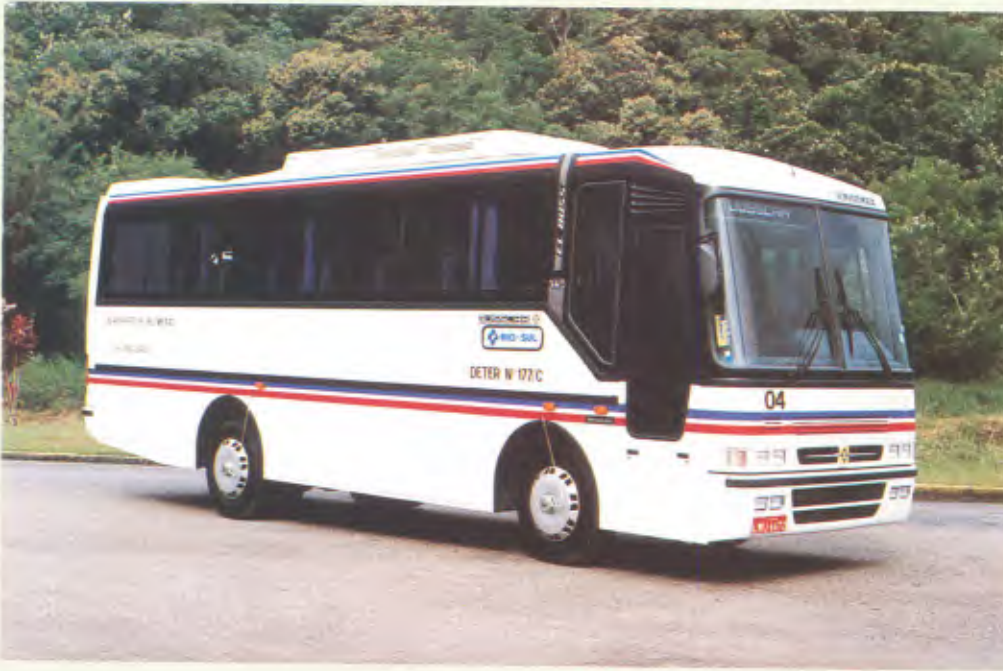
Carroceria/ Carroceria: El Buss 340/Midibus Aplicação/ Aplicacion: Rodoviária Chassis que podem ser encarroçados/ Chasis que pueden ser ensamblados: Ford, Mercedes-Benz (foto), Volkswagen.
