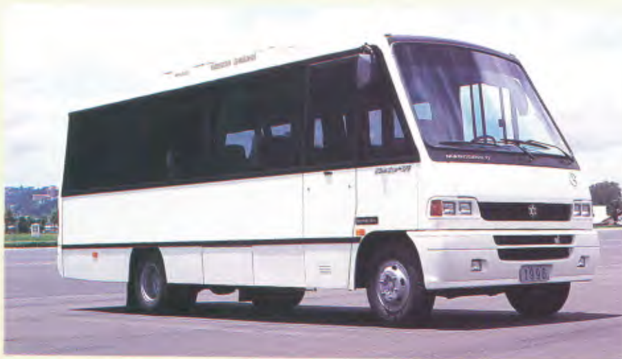
Carroceria/Carroceria: Micro Senior GV Aplicação/Aplicacion: Turismo Chassis que podem ser encarroçados/Chasis que pueden ser ensamblados: Mercedes-Benz (foto), Volkswagen.
