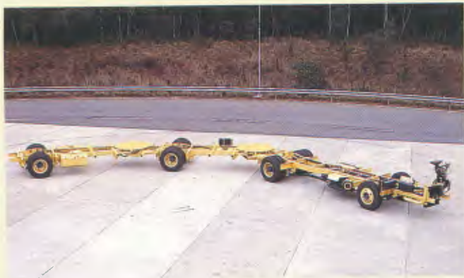
Chassi-modelo/Chasi-modelo: B 58 ECO Bi-articulado Aplicação/Aplicacion: Urbana, desenvolvido sob encomenda para o sistema urbano de Curitiba, PR. Desarrollado bajo encomienda para el sistema urbano de Curitiba, PR.
