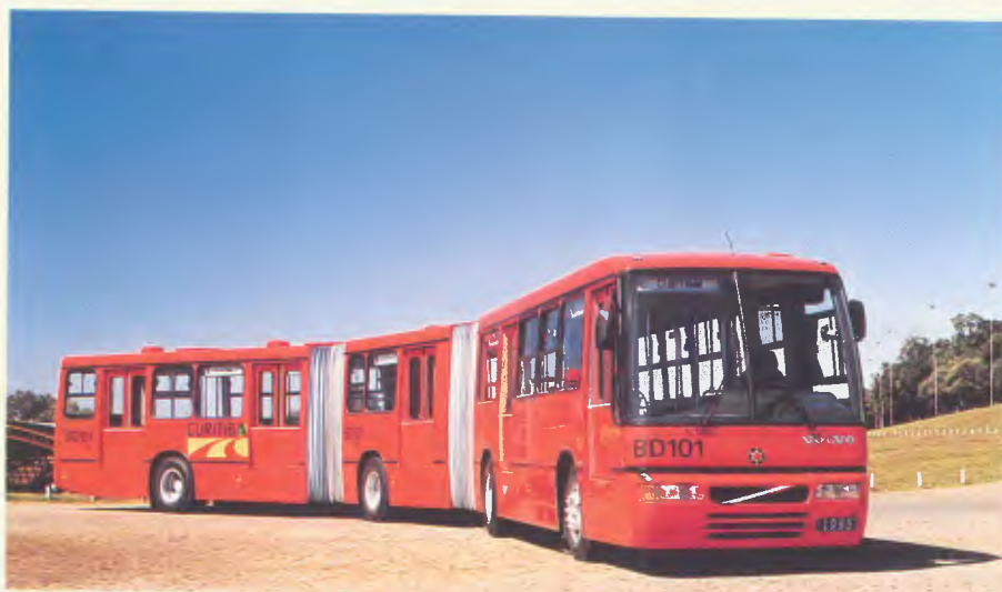
Carroceria/Carroceria: Bi-articulado Aplicação/Aplicacion: Urbana Chassis que podem ser encarroçados/Chasis que pueden ser ensamblados: Volvo B 58 E (foto).
