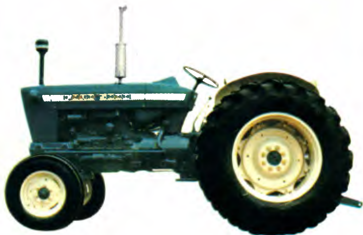
Trator Ford mod. 5.000 — Motor Diesel de 77,1 HP (S.A.E.) ● 2 100 rpm ● Transmissão de 8 marchas ● Tomada de força e levante hidráulico de 3 pontos ● Peso lastrado: 4.400 kg
