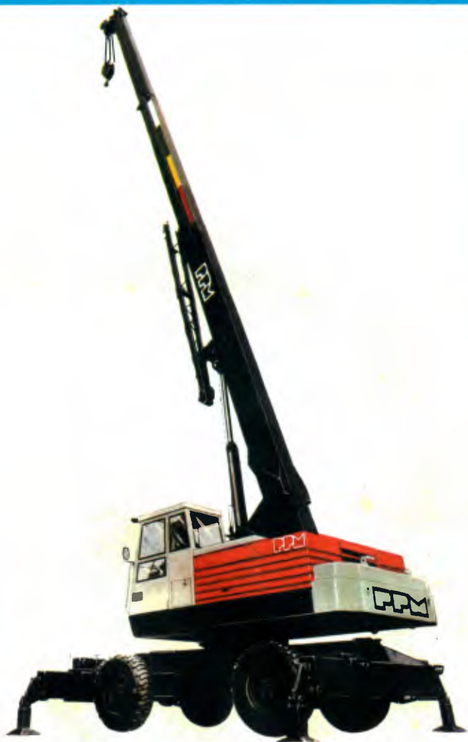
Guindaste hidráulico telescópico PPM. Mod. 18-15 Autopropelido ● Velocidade de estrada: 25 km/h ● Motor de 6 cil. diesel com 87 HP DIN ● Tração nas 4 rodas ● Capacidade: 20 t ● Lança telescópica hidráulica de 3 seções ● Altura máxima: 24 m.
