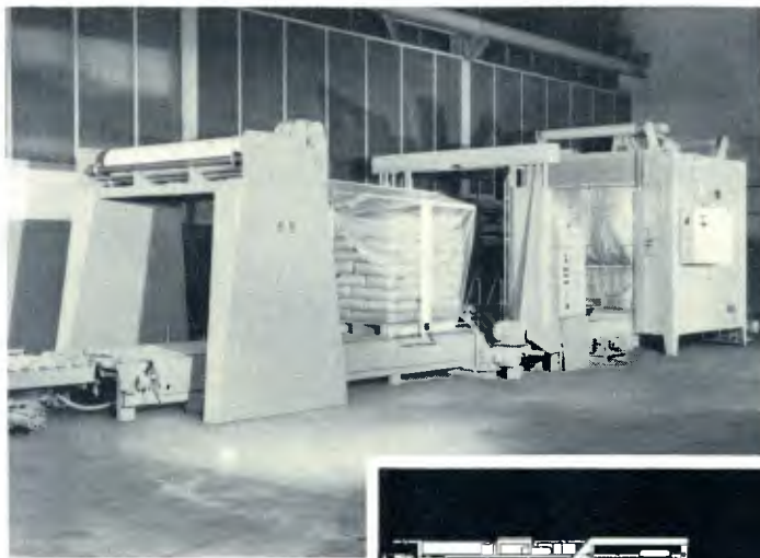
Linha de paletização, embalagem com folhas termo-retráteis e estufa de retração.
