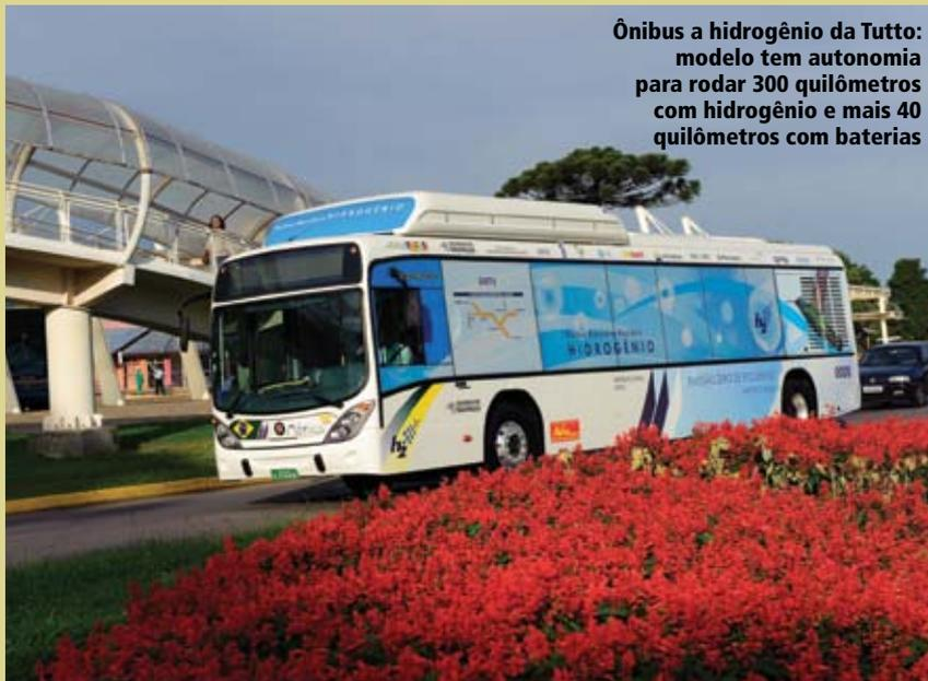
**Ônibus a hidrogênio da Tutto: modelo tem autonomia para rodar 300 quilômetros com hidrogênio e mais 40 quilômetros com baterias**
