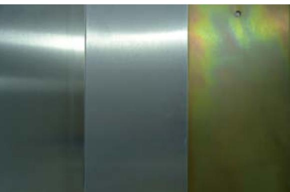
Da esquerda para a direita, exemplos de materiais: alumínio sem tratamento, chapa com cromatizante trivalente, em uso atualmente pela Marcopolo, e chapa com cromatizante hexavalente
