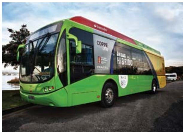
**Ônibus a hidrogênio da Coppe/UFRJ: modelo H2+2 tem autonomia para 500 quilômetros com hidrogênio e com bateria vai até 150 quilômetros**
