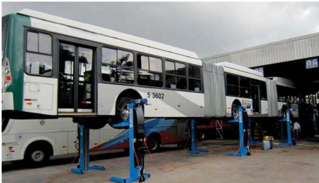
Colunas móveis de elevação para manutenção de ônibus articulados, biarticulados e veículos pesados
