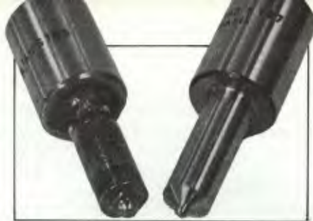
Um bico (esq.) corroído pela cavitação
