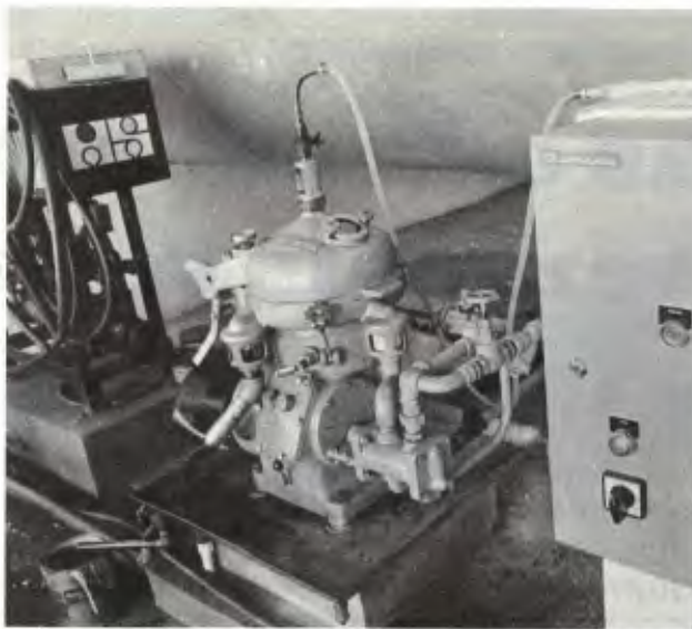
Centrifugadora da Alfa Laval, sem desgastes
