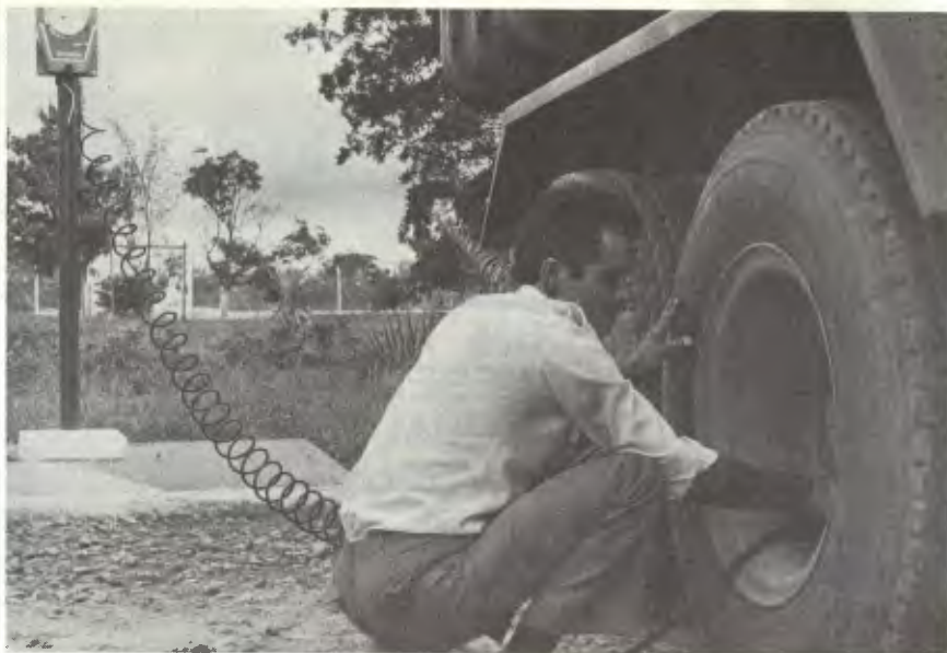
Um plano correto de calibragem pode poupar diesel e prolongar a vida dos pneus
