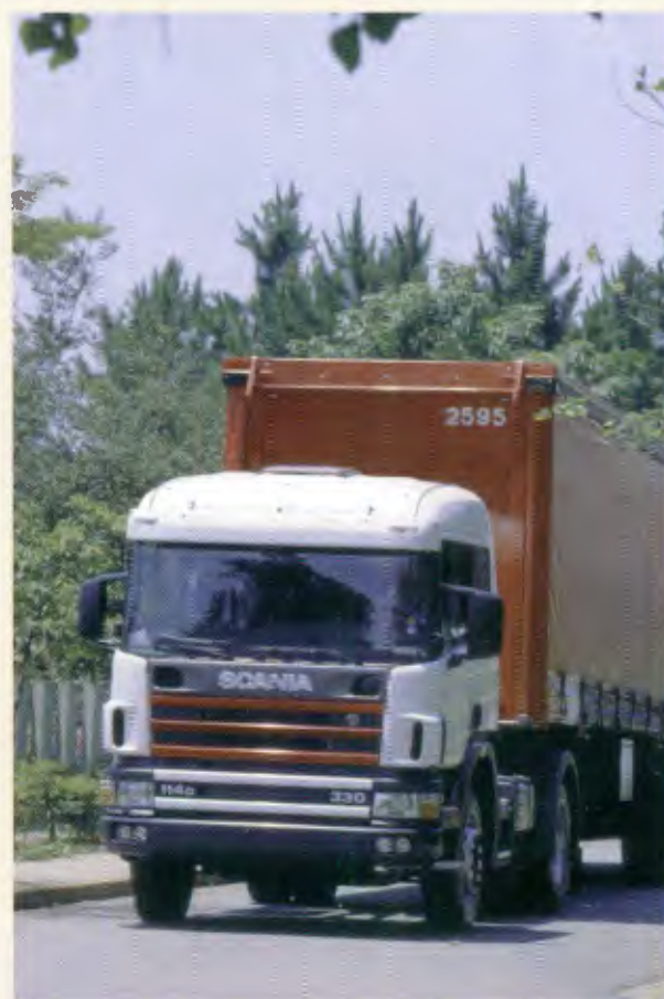
Modelo: GA4x2 330 Entre-eixos: 3.550 mm e 4.300 mm Motor: D911 07, 330 cv a 1.600-1.900 rpm PBT: 19.700 kg
