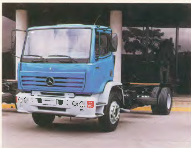
Modelo: 1723 4x2 Entre-eixos: 5.170 mm Motor: OM-366 LA, 231 cv PBT: 16.500 kg, 23.000 kg
