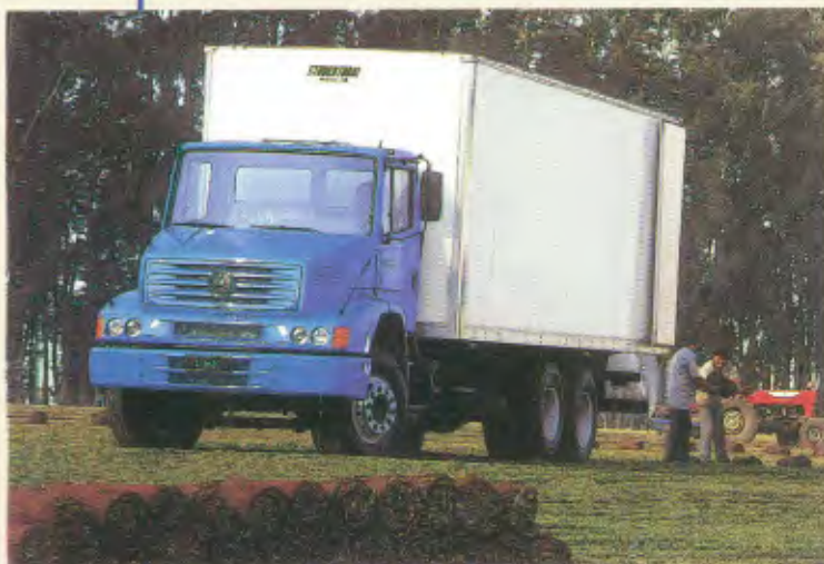
Modelo: L-1620 Truck 5x2 Entre-eixos: 5.170 mm Motor: OM-366 LA, 211 cv PBT: 22.000 kg
