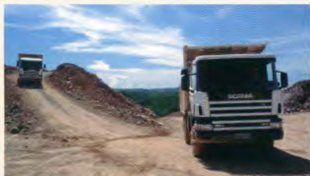
Modelo: CB6x4 NZ360 Entre-eixos: 3.300 mm, 4.700 mm Motor: DSC12 02, 360 cv a 1.600-1.900 rpm PBT: 38.500 kg
