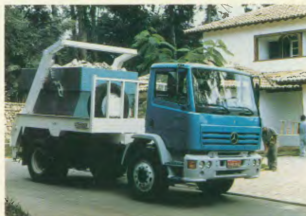
Modelo: 1718 K 4x2 Entre-eixos: 3.600 mm Motor: OIA-366 A, 170 cv PBT: 16.500 kg, 23.000 kg
