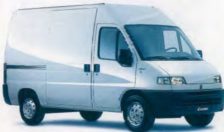
Modelo: Ducato Maxi Entre-eixos: 3.200 mm Motor: Sofim 2.8 Turbodiesel, 103 cv a 3.600 rpm PBT: 3.500 kg
