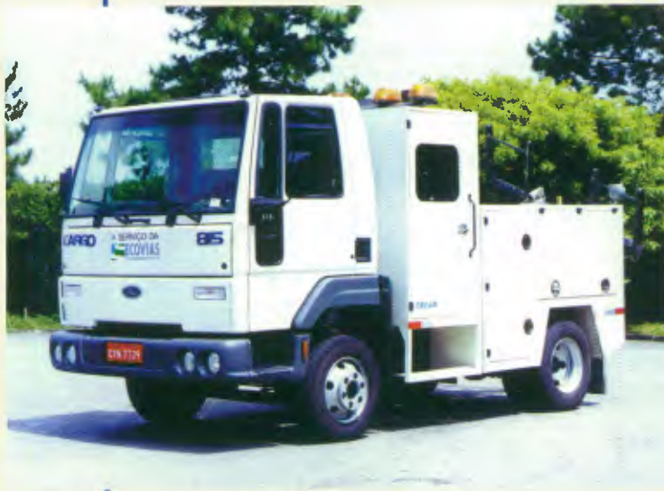
Modelo: Cargo 815 4x2 Entre-eixos: 2.800 mm, 3.300 mm, 3.900 mm Motor: Cummins B3.9 150 CIV, 152 cv a 2.700 rpm PBT: 7.700 kg
