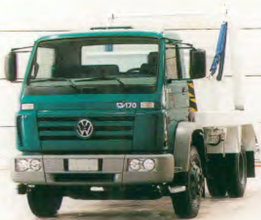
Modelo: 13-170 4x2 Entre-eixos: 3.560 mm, 4.340 mm, 4.870 mm, 5.207 mm Motor: Cummins 6BTA, 160 cv a 2.600 rpm PBT: 12.900 kg
