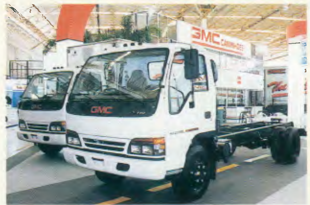
Modelo: 7-110 4x2 Entre-eixos: 3.830 mm Motor: Isuzu 4HF1, 106 cv a 3.260 rpm PBT: 6.700 kg
