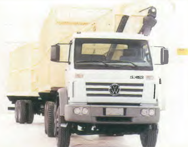
Modelo: 26-300 6x4 Entre-eixos: 4.120 mm e 5.260 mm Motor: Cummins 6CTAA, 303 cv a 2.200 rpm PBT: 23.000 kg
