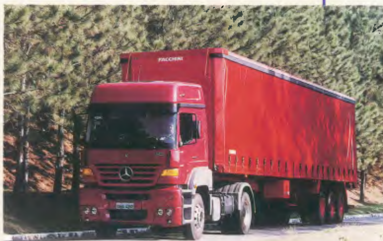
Modelo: LS-1938 4x2 Entre-eixos: 4.600 mm Motor: OM-457 LA, 390 cv PBT: 19.500 kg
