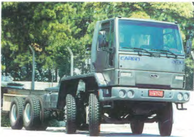
Ford Cargo 2630 na configuração 8x4, com dois eixos dianteiros direcionais disputa o mercado de semipesados e permite maior volume de carga
