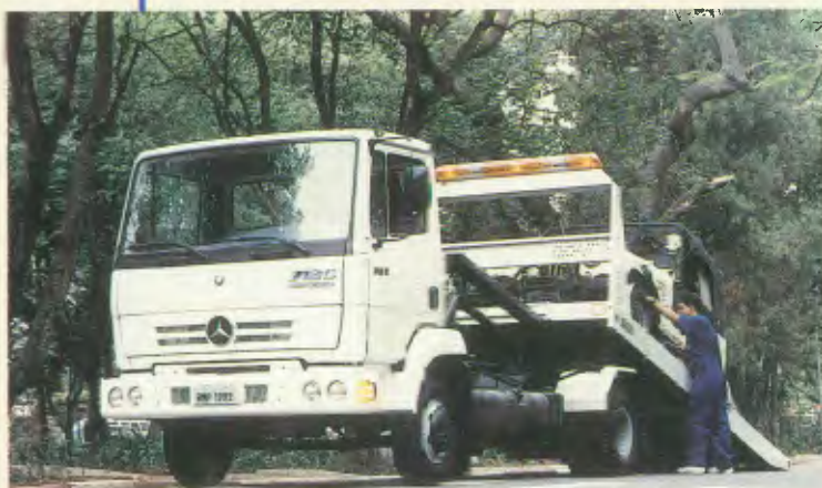
Modelo: 1718 K 4x2 Entre-eixos: 3.600 mm Motor: OIA-366 A, 170 cv PBT: 16.500 kg, 23.000 kg
