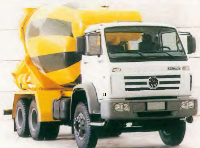
Modelo: 24-250 6x4 Entre-eixos: 4.120 mm, 5.260 mm Motor: Cummins CTAA, 250 cv a 2.200 rpm PBT: 23.000 kg
