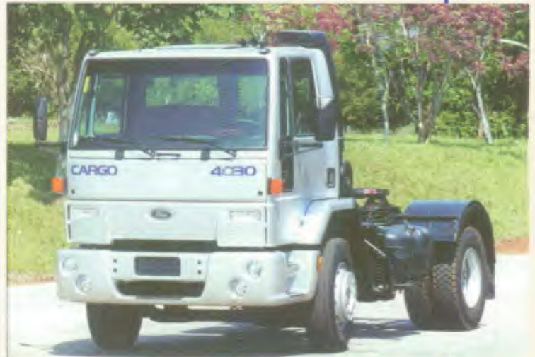
Modelo: Cargo 4030 4x2 Entre-eixos: 3.560 mm Motor: Cummins 6CTAA, 291 cv a 2.200 rpm PBT: 15.000 kg
