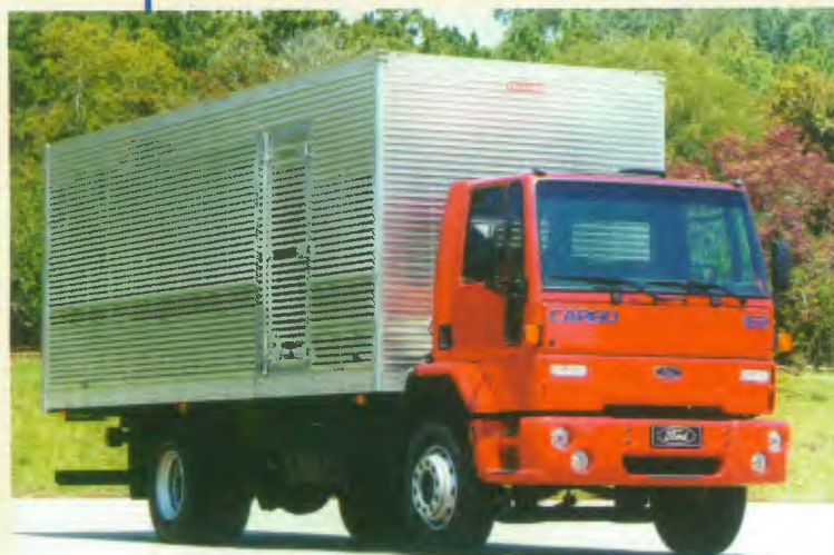
Modelo: Cargo 1621 4x2 Entre-eixos: 4.340 mm, 4.800 mm Motor: Cummins B5.9 205 CIV, 208 cv a 2.600 rpm PBT: 16.000 kg
