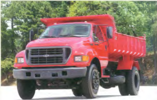
Modelo: Cargo 2425 6x4 Entre-eixos: 3.440+1.360 mm, 4 580+1.360 mm Motor: Cummins 6CTAA, 250 cv a 2.200 rpm PBT: 23.000 kg
