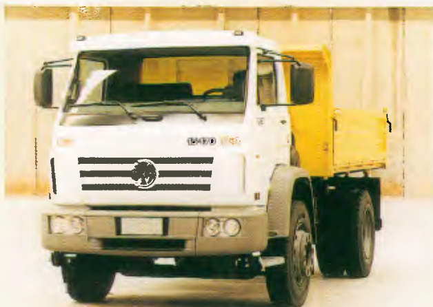
Modelo: 15-170 4x2 Entre-eixos: 3.560 mm, 4.340 mm, 4.800 mm, 5.207 mm Motor: Cummins 6BTA, 160 cv a 2.600 rpm PBT: 14.500 kg
