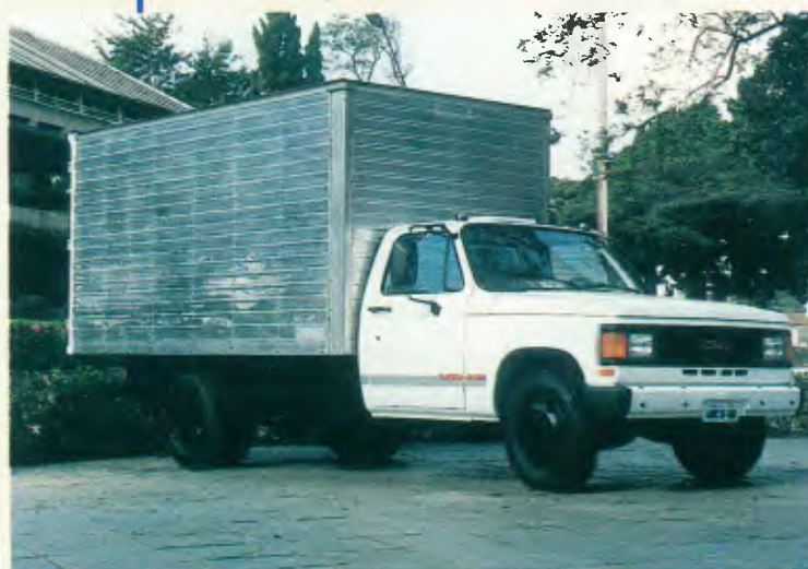
Modelo: 6-150 4x2 Entre-eixos: 4.050 mm Motor: MWM 6.07 THD, 140 cv a 3.000 rpm PBT: 6.300 kg
