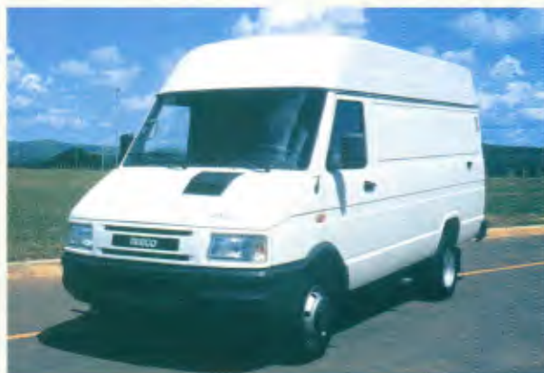
Modelo: Daily Furgão Entre-eixos: 3.300 mm, 3.950 mm Motor: Iveco 8140.23, 103 cv a 3.600 rpm, e 8140.43, 122 cv a 3.600 rpm PBT: 4.000 kg, 5.200 kg
