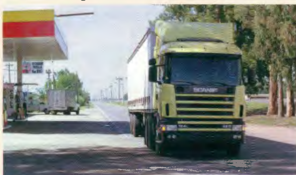
Modelo: LA6x2 NA420 Entre-eixos: 3.100 mm, 3.500 mm, 3.900 mm Motor: DSC12 05, 420 cv a 1.700-1.800 rpm PBT: 25.700 kg
