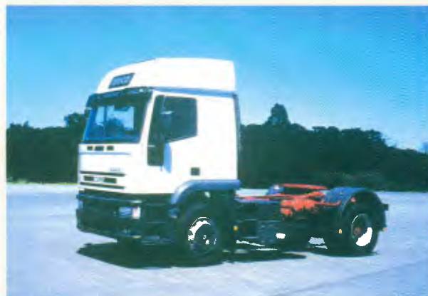
Modelo: Eurotech Entre-eixos: 3.800 mm Motor: Iveco 8210, 370 cv a 1.900 rpm PBT: 20.000 kg
