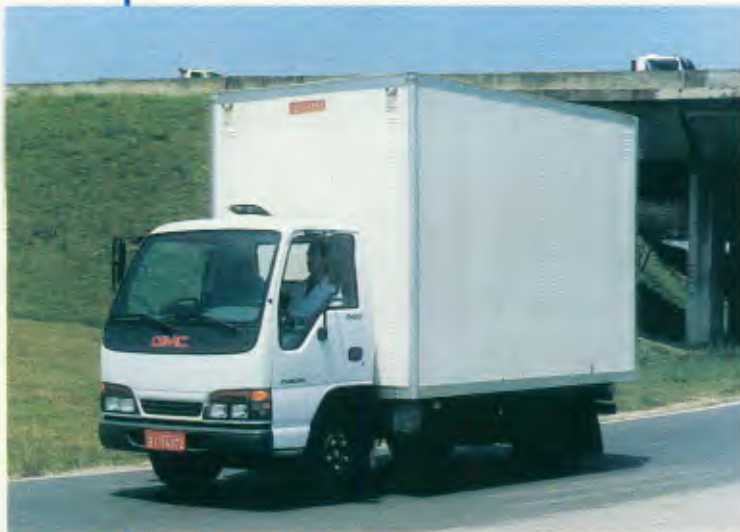
Modelo: 5-90 4x2 Entre-eixos: 3.360 mm Motor: Isuzu 4JG2, 83 cv a 3.400 rpm PBT: 5.020 kg
