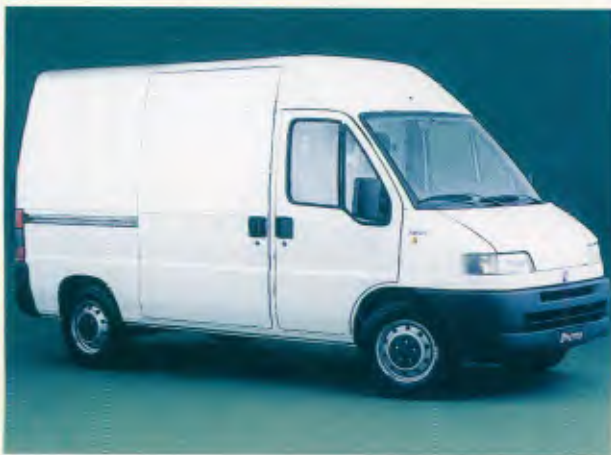
Modelo: Ducato 15 Entre-eixos: 2.850 mm Motor: Sofim 2.8 Turbodiesel, 103 cv a 3.600 rpm PBT: 3.300 kg
