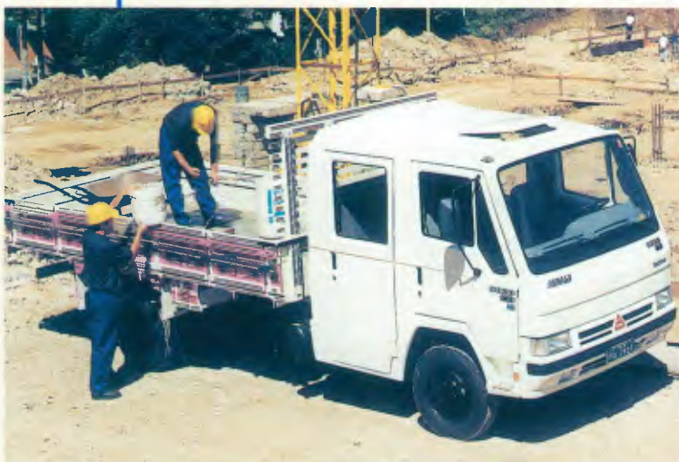
Modelo: 6000 Cabine Dupla 4x2 Entre-eixos: 3.350 mm, 3.900 mm Motor: MWM, 131 cv a 3.500 rpm PBT: 5.900 kg
