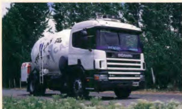
Modelo: DB4x2 NZ260 Entre-eixos: 4.700 mm, 5.100 mm, 5.300 mm Motor: DSC9 12, 260 cv a 2.000 rpm PBT: 19.700 kg
