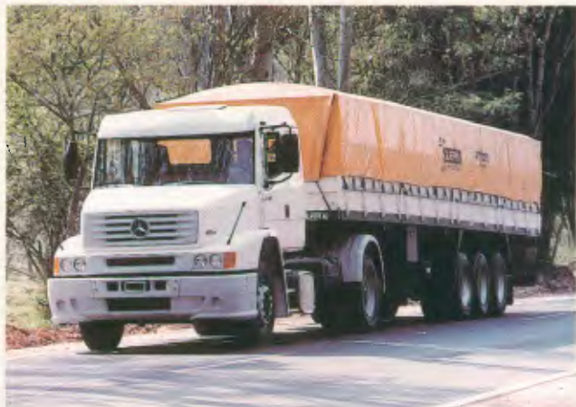
Modelo: LS-1632 4x2 Entre-eixos: 4.500 mm Motor: OM-449 LA, 320 cv PBT: 17.300 kg
