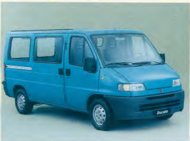
Modelo: Vetrato Entre-eixos: 3.200 mm Motor: Sofim 2.8 Turbo diesel, 103 cv a 3.600 rpm PBT: 3.300 kg
