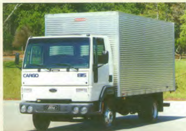
Modelo: Cargo 815 4x2 Entre-eixos: 2.800 mm, 3.300 mm, 3.900 mm Motor: Cummins B3.9 150 CIV, 152 cv a 2.700 rpm PBT: 7.700 kg
