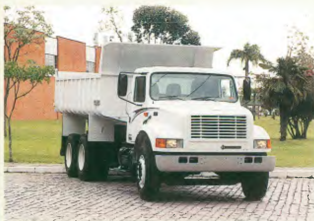
Modelo: 4900 Entre-eixos: 4.572 mm, 5.537 mm Motor: International DT466E, eletrônico, 263 cv a 1.900 rpm PBT: 16.000 kg, 24.000 kg
