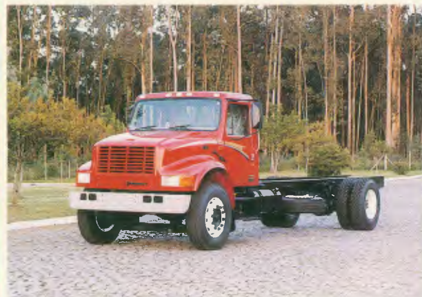
Modelo: 4700 Entre-eixos: 5.537 mm Motor: International T444E, eletrônico, 197 cv a 2.300 rpm, DT466E, 213 cv a 2.300 rpm PBT: 16.000 kg
