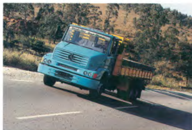
Semipesado L 1622 6x2, de fábrica, tem 2 m a mais em comprimento e 7 t a mais no peso bruto total
