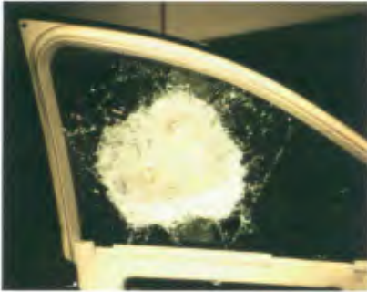
Vidro deve resistir a pelo três tiros em área próxima
