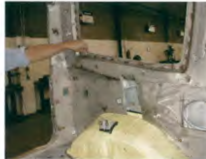
“Overlap” em aço protege área vulnerável nos vidros blindados
