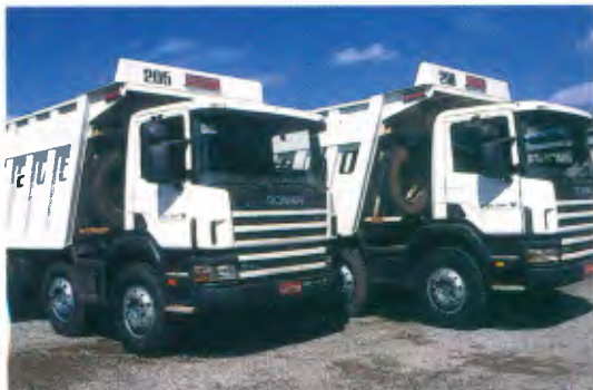
Caminhões 8x4 dispõem de freio auxiliar Scania Retarder e horímetro
