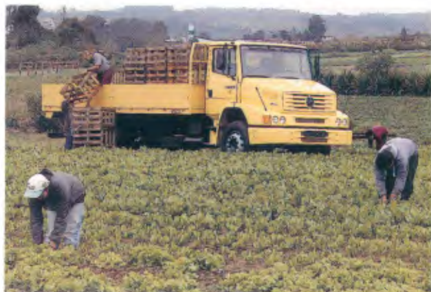
O médio L 1218 EL, para transportar produtos de baixo peso, admite carrocerias de até 6,8 m na versão 4x2
