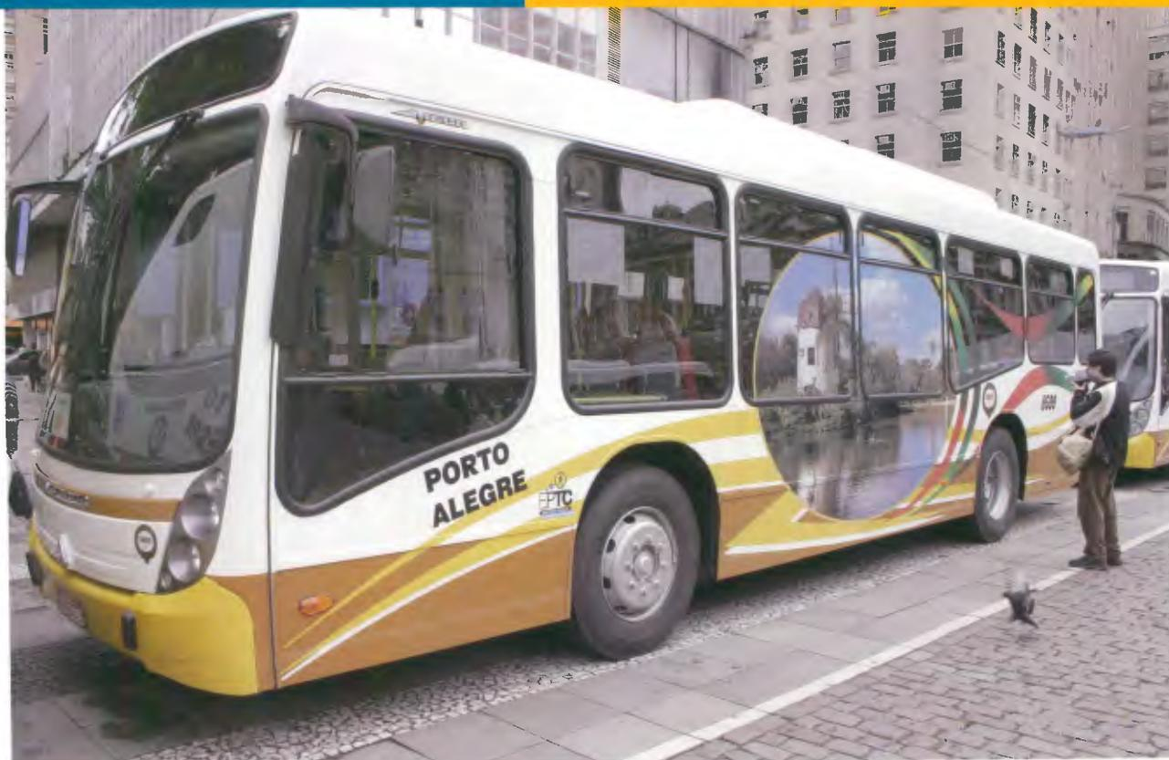
Ônibus MT 12.0 LE, com piso baixo, motor traseiro e equipados com TV e telefone público, em operação em Porto Alegre
