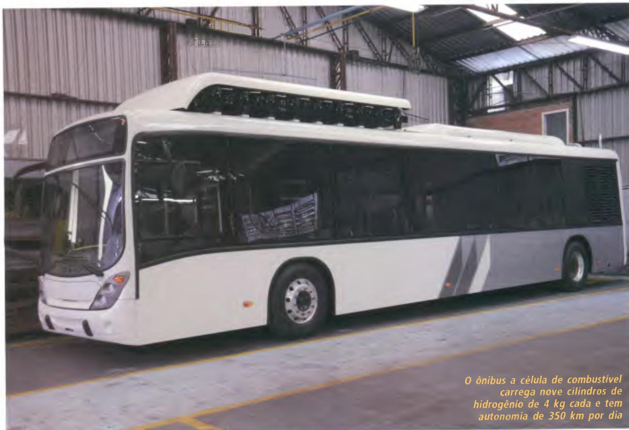
*O ônibus a célula de combustível carrega nove cilindros de hidrogênio de 4 kg cada e tem autonomia de 350 km por dia*
