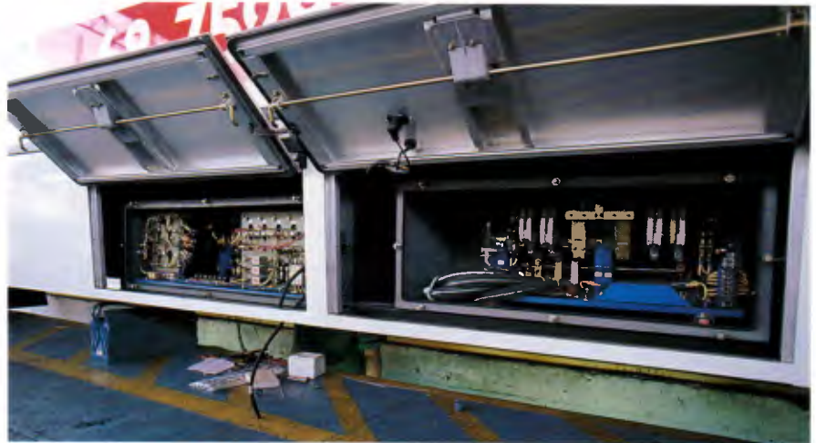
Conjuntos eletro-eletrônicos auxiliares foram simplificados
