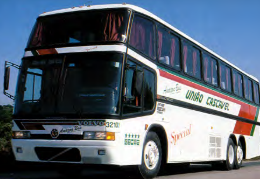
Amazon Bus: um dos 70 ônibus especiais com chassi Volvo B10M e carroceria Marcopolo Paradiso
