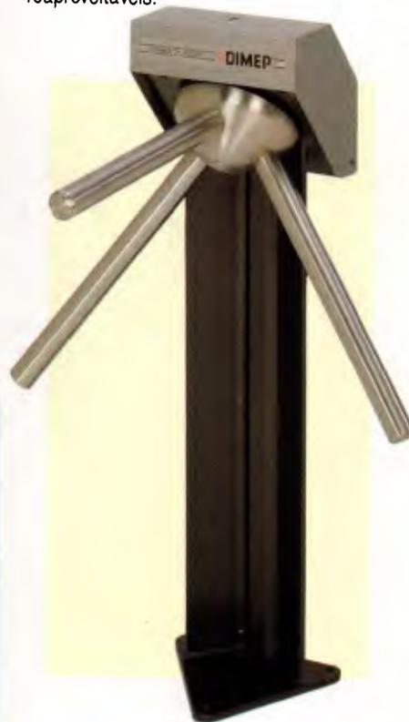
As catracas têm 945 mm de altura total e da base aos braços 830 mm, os braços são em inox e o corpo em ferro epoxi. A da foto é uma catraca mecânica, cujos braços, três no total, têm 400 mm de comprimento. O contador pode ser colocado na parte superior ou na lateral, voltado para o cobrador. A base é triangular com três furos para fixação.
