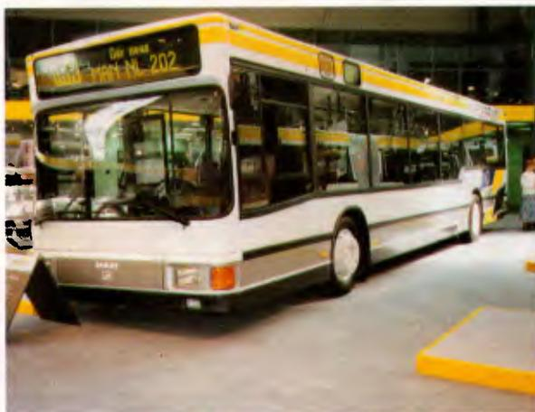
**MAN com piso totalmente plano: sistemas elétrico e de ar foram colocados no teto**
