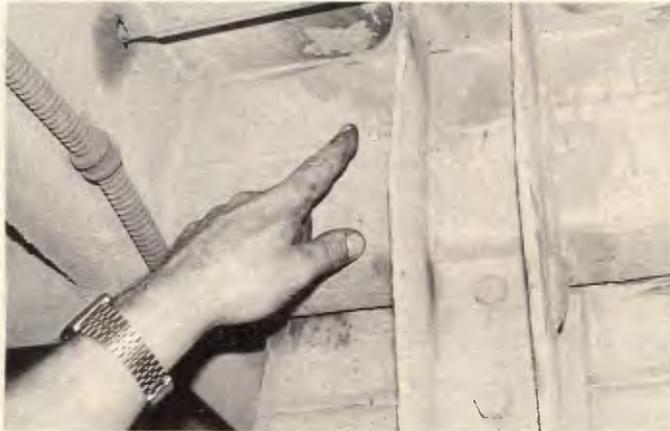
Reforço triangular com pontos de solda na junção do eixo traseiro com a longarina para impedir novas trincas reparadas com solda; o esforço lateral na altura do eixo, no entanto, continua
