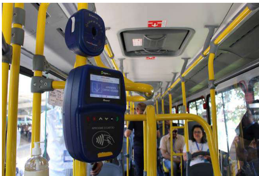
Sistema de bilhetagem da Empresa 1 na cidade de Guarapari (ES), contempla 60 veículos, 60 validadores com GPS/4G/QR CODE e 60 câmeras para uso de reconhecimento facial
