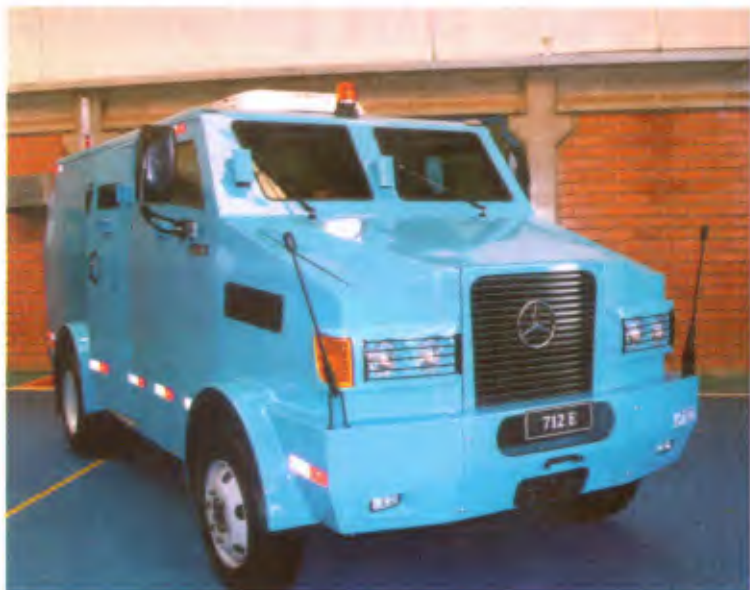
O modelo 712 E, com motor de 115 cv, para 7 t de pbt e a versão 915 E, com motor eletrônico, de maior potência
