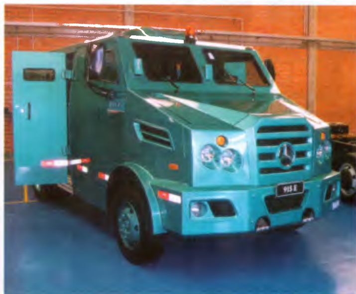
O modelo 712 E, com motor de 115 cv, para 7 t de pbt e a versão 915 E, com motor eletrônico, de maior potência
