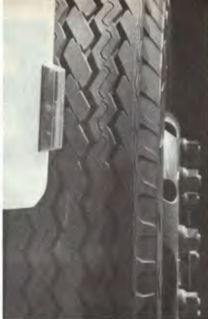
A lanterna do pára-lama é má localizada. A Ford diz que é para poder ser vista por automóveis. Aleta da coluna desvia o ar para evitar sujeira na porta e retrovisor
