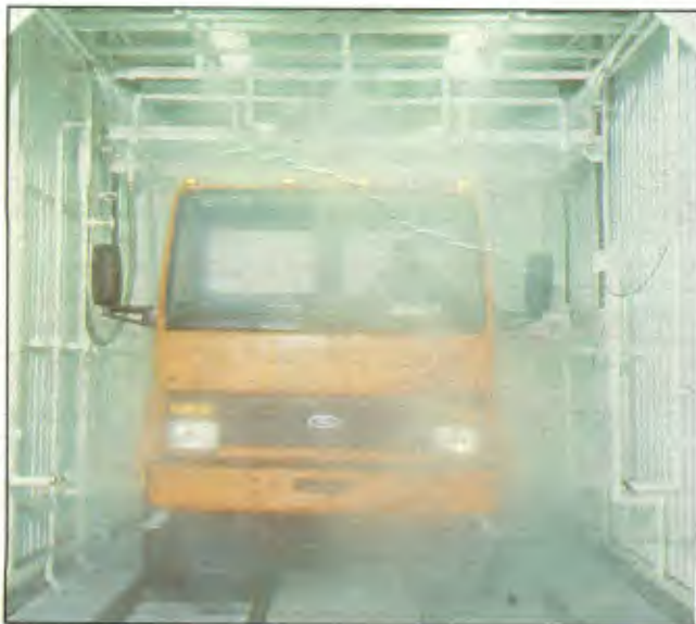
Cêra protege a pintura eletroforética contra corrosão
