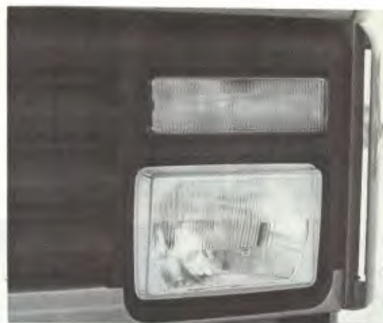
A lanterna do pára-lama é má localizada. A Ford diz que é para poder ser vista por automóveis. Aleta da coluna desvia o ar para evitar sujeira na porta e retrovisor
