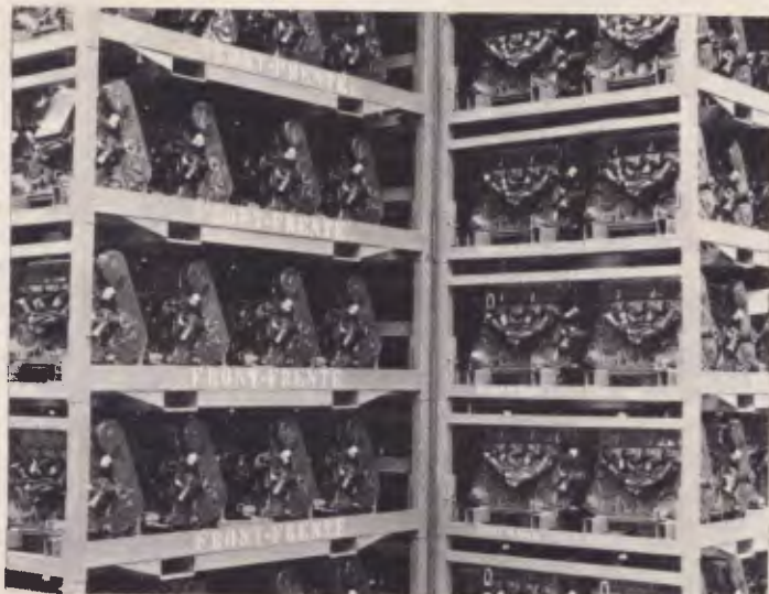
Os estrados podem ser empilhados e cada um comporta 8 motores.
