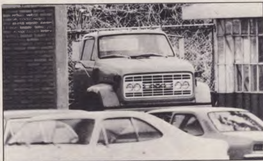
Um dos modelos em teste no pátio do departamento de engenharia da fábrica, em São José dos Campos chama a atenção pelos quatro faróis dispostos em linha e pelo capô inteiramente escamoteável.
