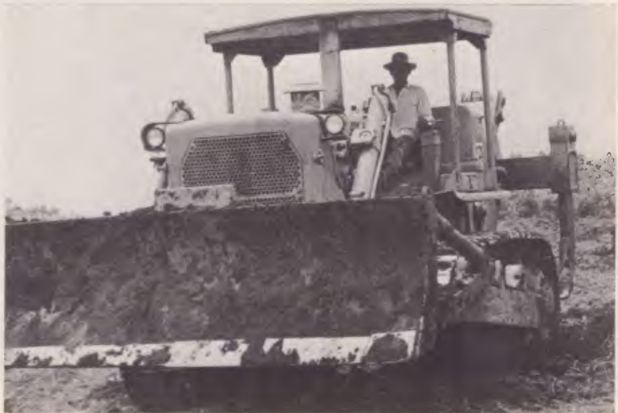
A poeira e a qualidade do operador fazem variar as curvas de produção das lâminas
