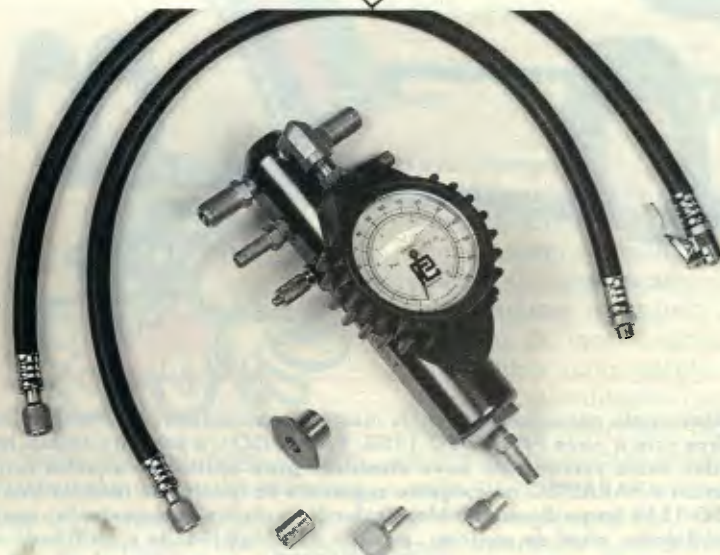
Peças que compõem o kit, calibrador e aferidor, servem para todo tipo de pneu
