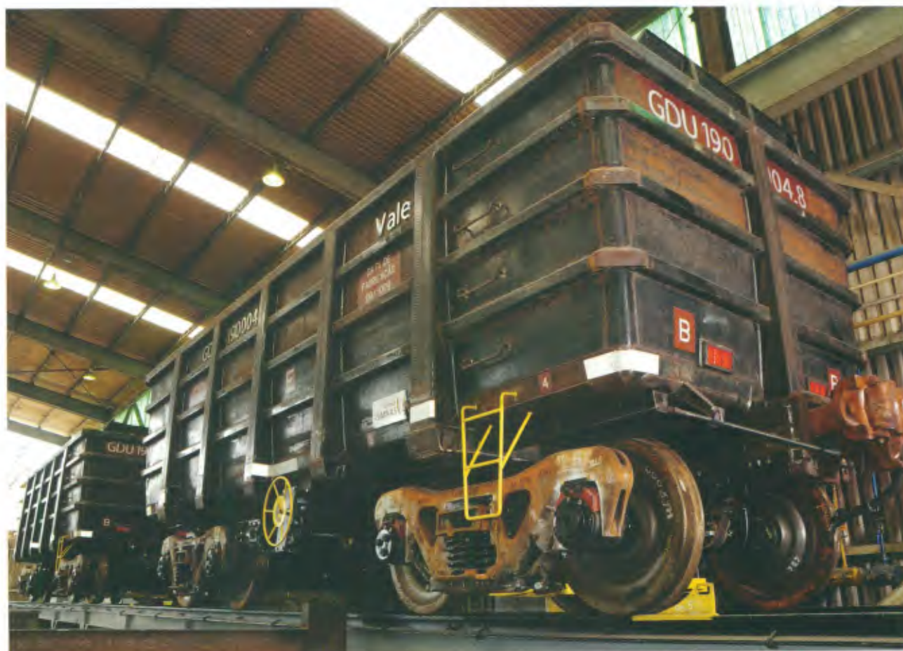
Os vagões GDU da Usiminas Mecânica para o transporte de minério são os maiores produzidos no Brasil
