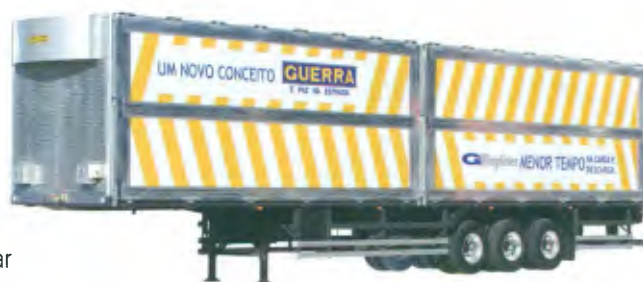
G Wingliner da Guerra tem sistema hidráulico para abertura das laterais
