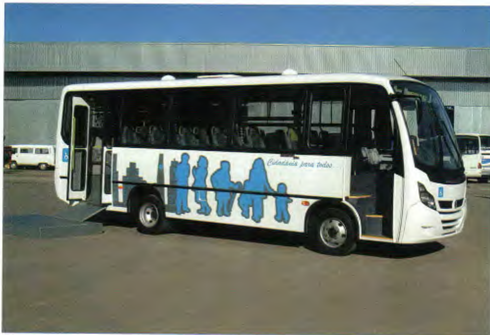
Carroceria com rampa na porta traseira para acesso de deficientes
