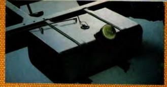
Equipado com tanque de combustível de 100 litros (opcionalmente 150 litros) os VW 6.80 e VW 6.90 têm grande autonomia operacional, possibilitando melhor controle no abastecimento.
