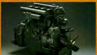
Modelo VW 6.90: equipado com o consagrado motor MWM D.229-4, de 4 cilindros em linha, injeção direta, 91 cv a 3000 rpm, com torque máximo de 26,5 m.kgf a 1600 rpm (norma DIN).
