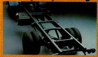
A cabina avançada dos VW 6.80 e VW 6.90 propicia a oferta da maior plataforma de carga em sua classe, alcançando 4,45 metros de comprimento, capaz de receber qualquer tipo de carroçaria, garantindo perfeita distribuição de peso nos eixos dianteiro e traseiro.
