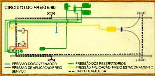
No modelo VW 6.90, o freio de serviço é hidráulico, auxiliado por ar comprimido, com triplo circuito, atuando independentemente nas rodas dianteiras/traseiras e uma via exclusiva para o freio de estacionamento, que atua nas rodas traseiras através de molas acumuladoras (spring brake).
