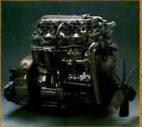
Modelo VW 6.80: equipado com motor Perkins "Premium" 4.236, especialmente desenvolvido para atender as exigentes normas Volkswagen. 4 cilindros em linha, injeção direta, 85 cv a 2800 rpm; com torque máximo de 25,6 m.kgf a 1600 rpm (norma DIN).
