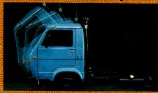
A cabina, dotada de sistema manual de basculamento, é uma exclusividade no segmento de caminhões leves, possibilita rápido e total acesso ao conjunto propulsor sem que o mecânico entre na cabina, reduzindo substancialmente o tempo necessário para manutenções.
