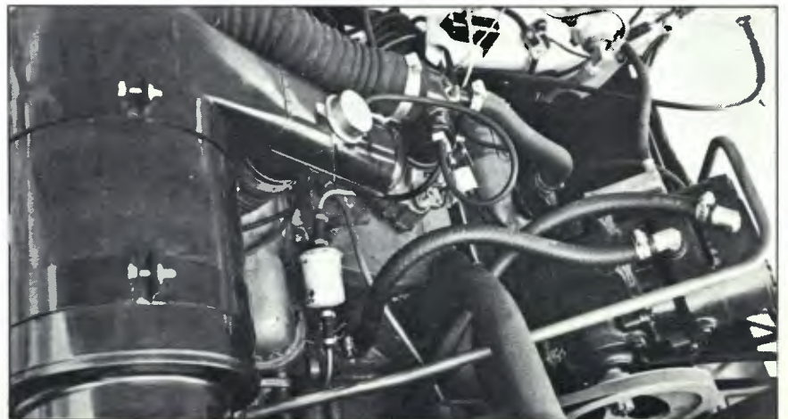
O motor V8-318: potência líquida 156 cv/ABNT e torque de 36,2 kgf
