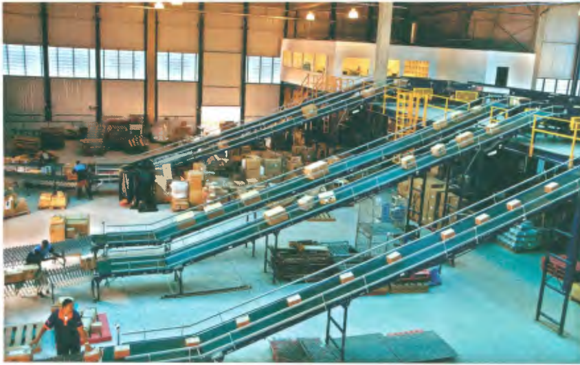
O sorter tem 4,7 mil metros de esteira e capacidade para processar e separar 140 volumes por minuto, ou 8.400 mil por hora, cuja operação é monitorada pelo centro de gerenciamento
