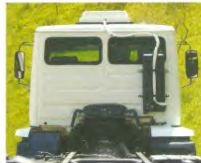
A blindagem realizada pela Auto Life pode ser realizada na cabine de qualquer caminhão e adiciona cerca de 200 kg ao veículo
