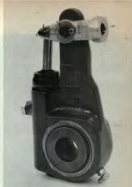
Ajustador automático: eficiente frenagem
