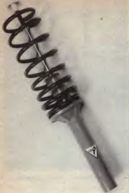
Koni: sistema de válvulas para reajuste
