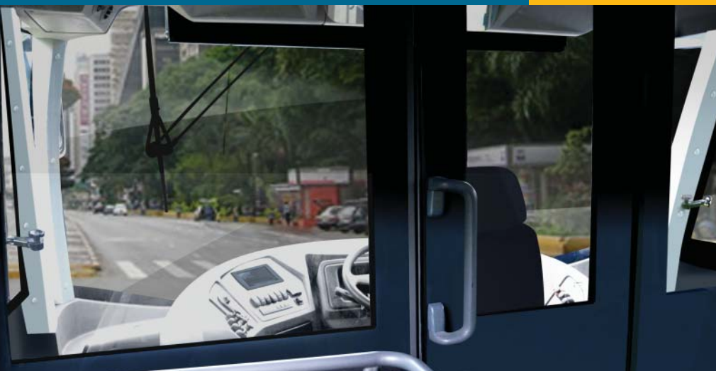
A posição central do motorista aumenta o campo de visão e facilita a dirigibilidade
