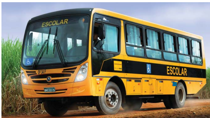
O ônibus OF 1519R tem versões de 9,4 m e 11 m de comprimento e motor de 185 cv
