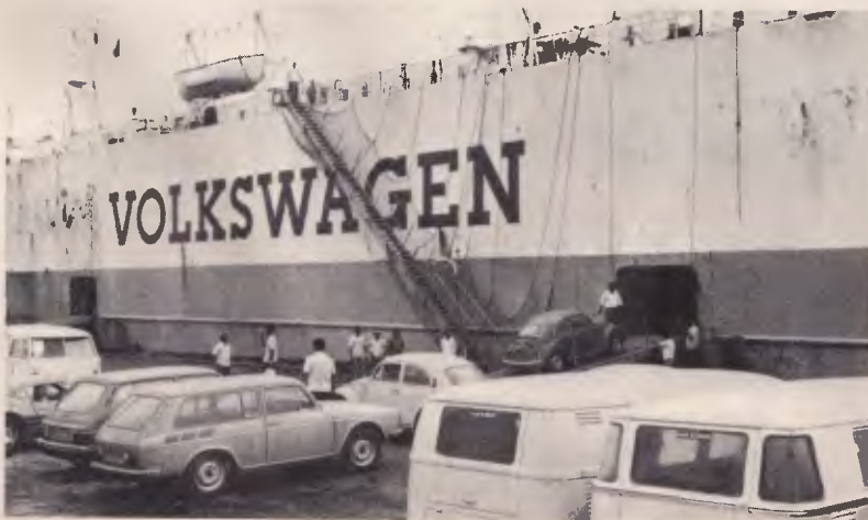
O roll-on-roll-off baseia seu funcionamento em embarcações especiais com duas portas de acesso aos carros
