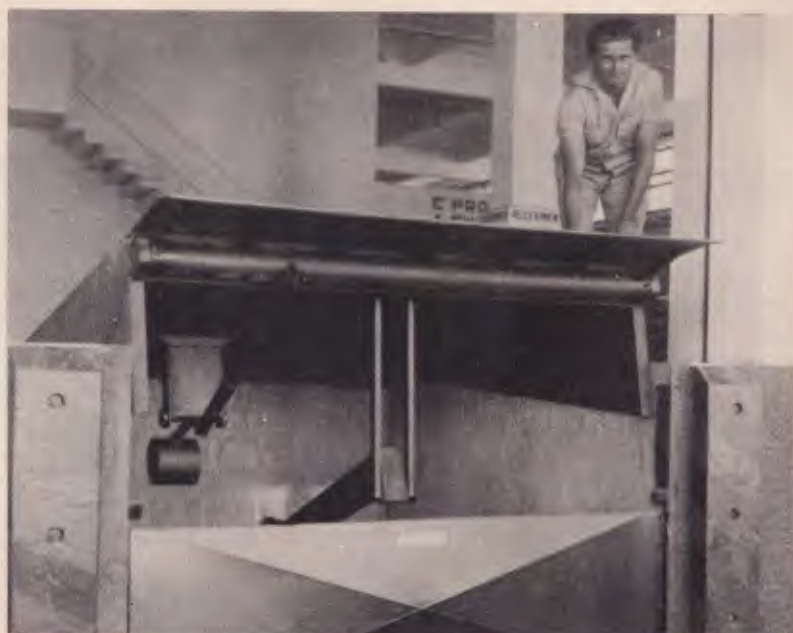
O esforço do operador é conjugado com o do contrapeso da plataforma.
