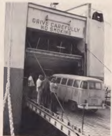
O roll-on-roll-off baseia seu funcionamento em embarcações especiais com duas portas de acesso aos carros
