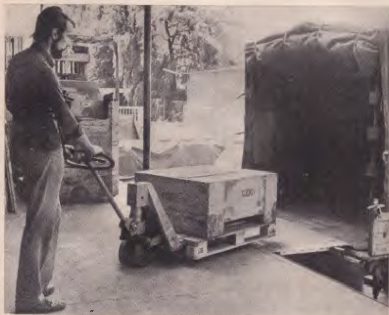
A plataforma desmontável pode ser aplicada em qualquer ponto da doca.
