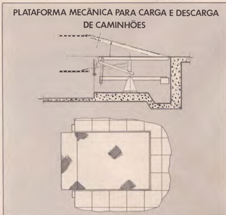
O Cargomax tem um sistema de contrapeso que auxilia o posicionamento.
