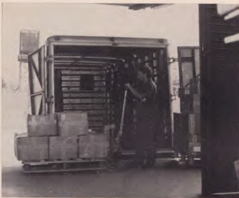
Com o desnível da carroçaria, a paleteira só pode trabalhar fora do furgão.
