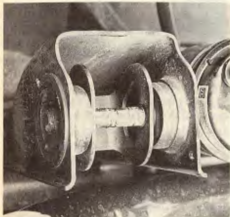
O motor, de seis cilindros, é forte e compacto. A caixa de câmbio dispensa anéis. O filtro é novo. A cabina tem quatro coxins de apoio e a roda é do tipo drop-center.
