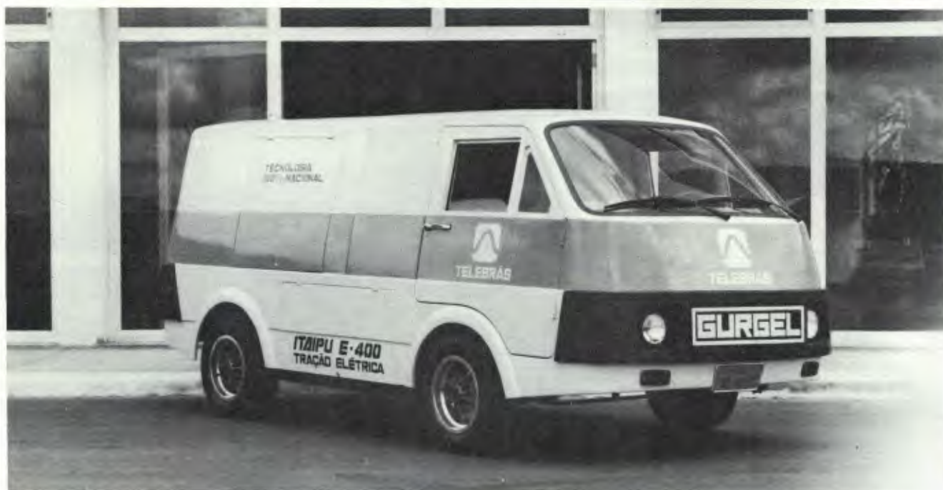
Itaipu E-400: o primeiro veículo elétrico movido a bateria que se faz no Brasil em regime industrial. As baterias pesam 520 kg e têm autonomia para 80 quilômetros.
