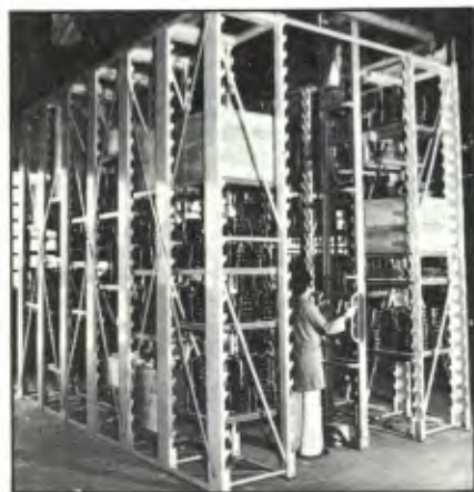
Stacker-crane: espaço restrito.
