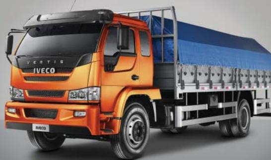
**Entre-eixos:** 4.185/4.815/5.175 mm las Parabólicas; Amortecedores Telescópicos de dupla ação; Barra estabilizadora
