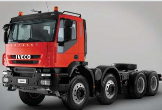
**Entre-eixos:** 3.500 / 4.500 mm Molas semi-elíptica; Amortecedores; Barra estabilizadora opcional. Traseira: Tipo Metálica / Tandem; Molas principais Semi-elíptica; Barra estabilizadora opcional.
