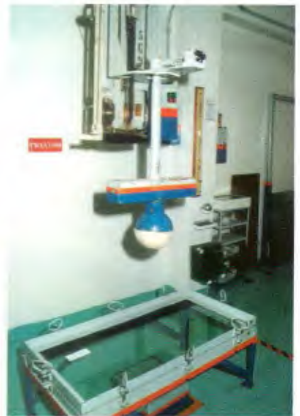
Teste de impacto de vidros laterais temperados
