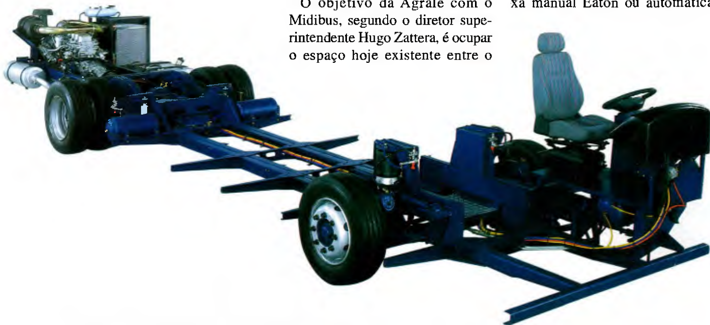
A família Agrale Midibus é composta por três modelos diferentes, com motor dianteiro ou traseiro, piso semibaixo ou piso baixo
