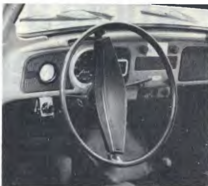
O seletor de combustível tem 4 posições
