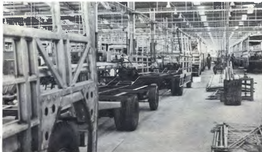
A Caio fabrica em sua única e nova unidade ônibus de aço e alumínio
