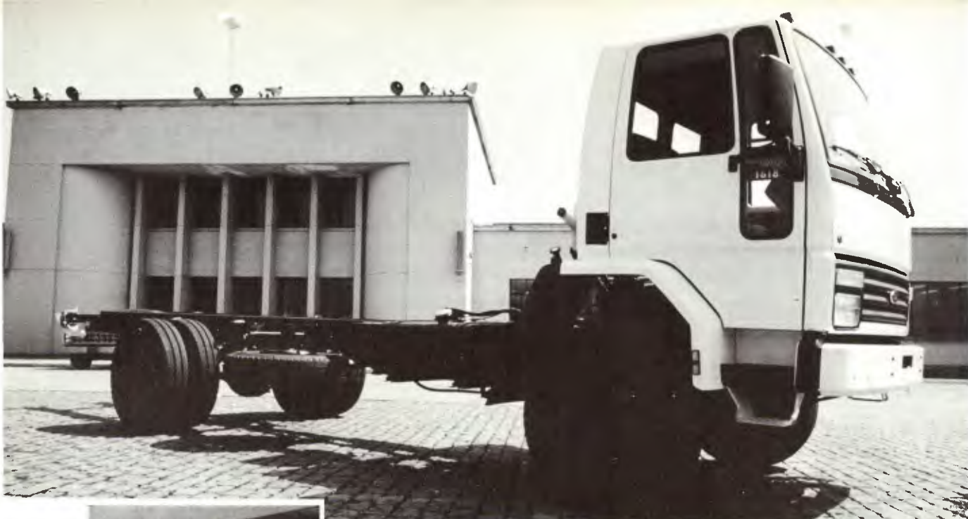
Derivado do 1618, o 2218 sai da fábrica com terceiro eixo e tem 168 cavalos
