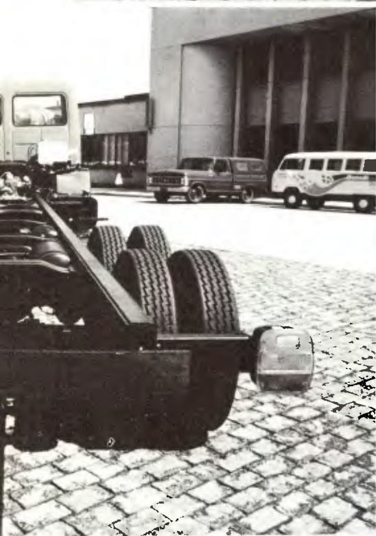
Derivado do 1618, o 2218 sai da fábrica com terceiro eixo e tem 168 cavalos
