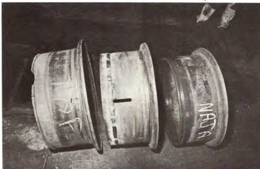
As três fases da recuperação: friso quebrado, novo friso soldado e a roda pronta
