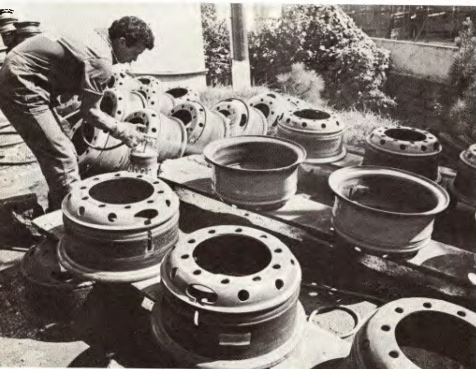
Para maior proteção, depois de reformadas, as rodas recebem nova pintura
