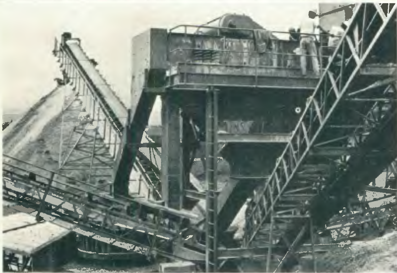
Versáteis, as correias possibilitam trajetos horizontais ou inclinados.
