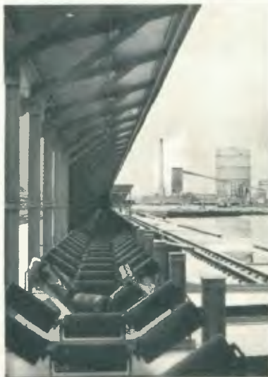
Rolêtes têm várias funções: apoiar, alinhar, amortecer e fazer retôrno.
