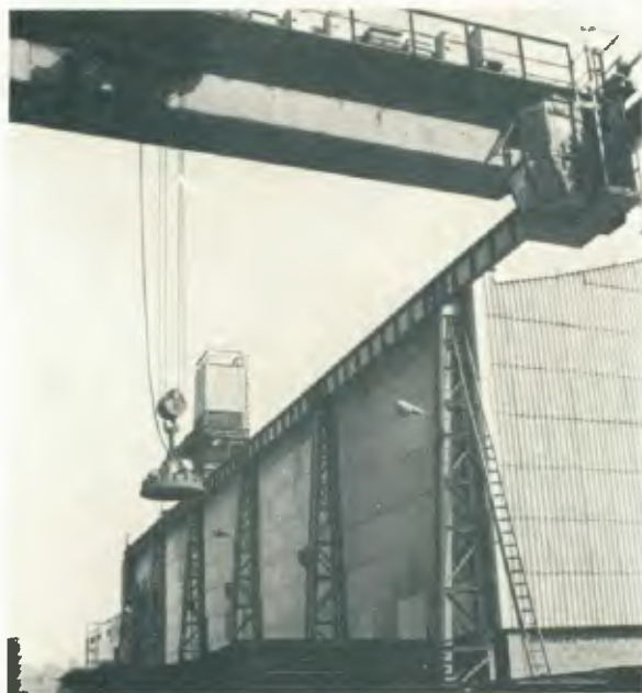
Eletoirmã pega chapas de 10 t sem estragar as bordas. Carrinho de refratário leva material para o forno.
