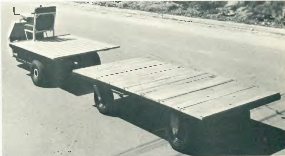
KK industrial: para cada caso, um projeto. Este modelo, com seis baterias de 6 V, traciona carrêtas a 9 km/h.
