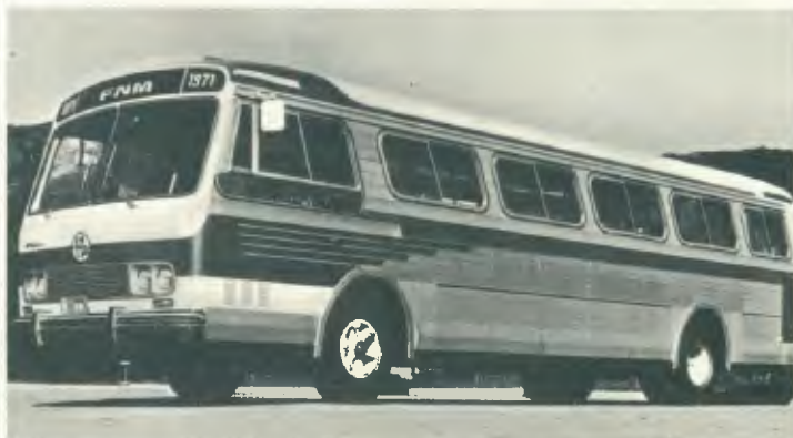
Nôvo ônibus FNM: motor traseiro com 196 HP, para 38 passageiros.
