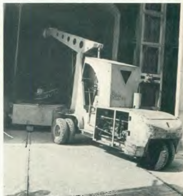
Eletoirmã pega chapas de 10 t sem estragar as bordas. Carrinho de refratário leva material para o forno.
