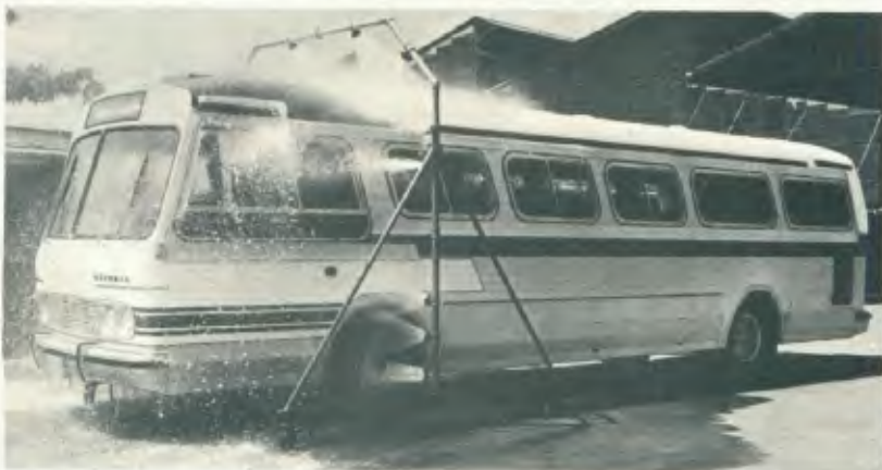
Chuva sob pressão para verificar a vedação: chuveiros bombardeiam ônibus.
