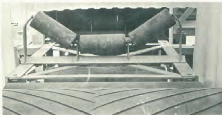
Rolêtes: espaçamento é função do peso da correia e do peso do material.
