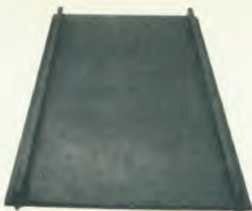
Correia transportadora com proteção lateral de borracha vulcanizada para evitar queda ou escape de material
