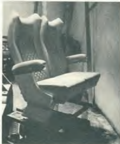
O excêntrico simula estrada ruim e o "brunômetro" testa a eficiência da espuma.
