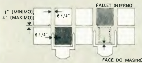
Ao lado: funcionamento do garfo de longo alcance. Ao alto: planta de estocagem pelo sistema convencional (348 pallets). Em baixo: mesma área; pelo sistema de longo alcance é possível colocar 580 pallets, usando cinco planos de carga.
